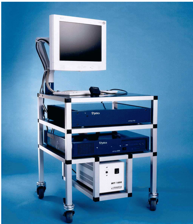
Abb. 10 : OCT-Gerät der Firma 4optics AG bestehend aus dem Basisgerät sirius713 und dem flexiblen Dermatologiehandstück
