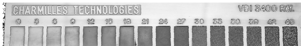
Bild 2-11: Erodierstrukturplatte nach DIN 3400
