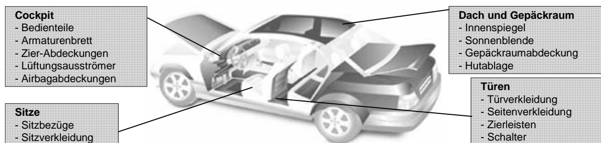
Bild 2-2: Typische Interieur-Trim-Bauteile [DANN04, S. 2]
