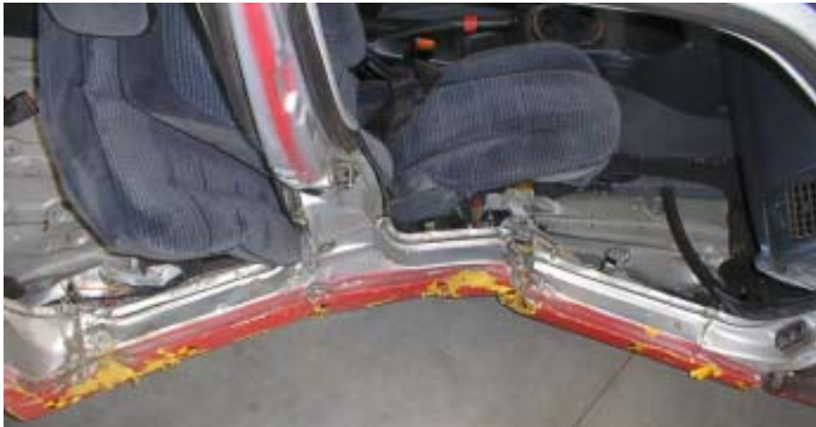
Abbildung 128: Golf Schweller und B-Säule (real)
