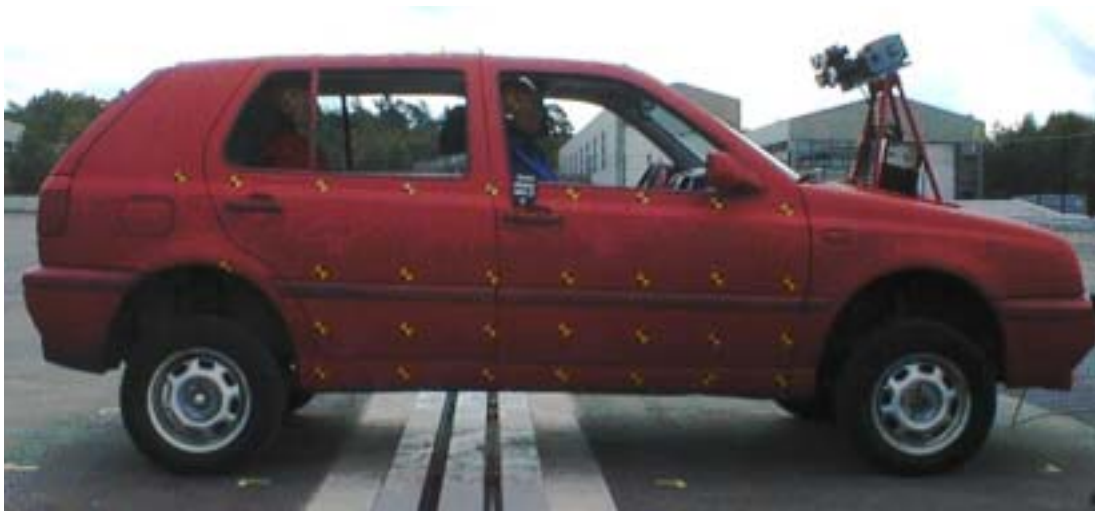
Abbildung 101: VW Golf um 100 mm angehoben
