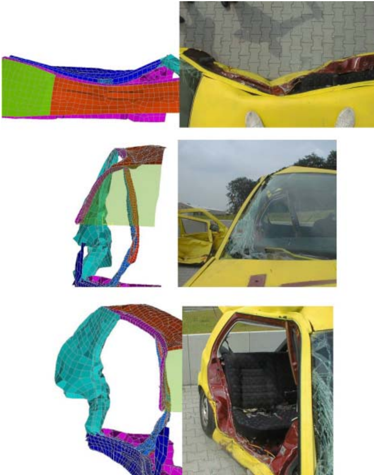
Abbildung 86: Karosseriedeformation des VW Golf aus verschiedenen Perspektiven im Vergleich numerisch / real
