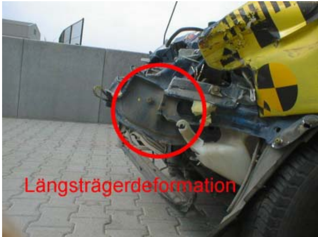
Abbildung 109: Deformation Längsträger links
