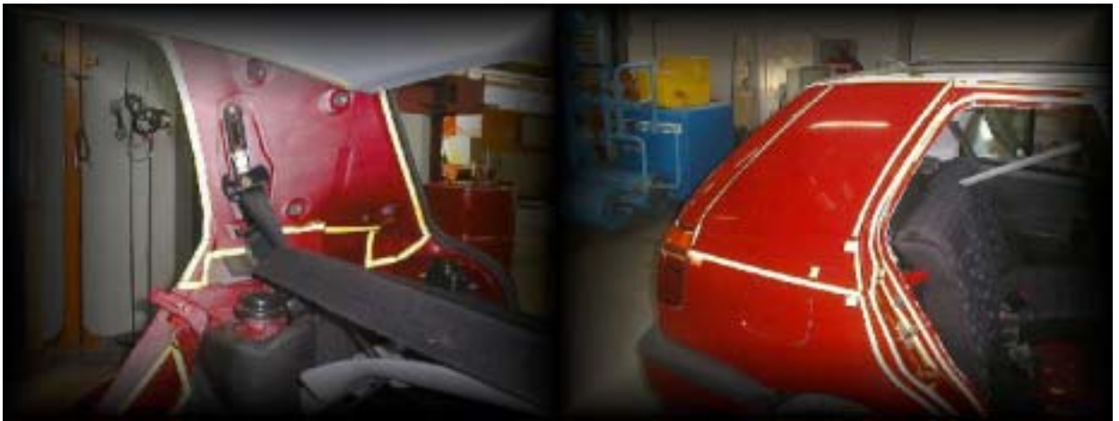
Abbildung 142: Außen- und Innenblech der C-Säule
