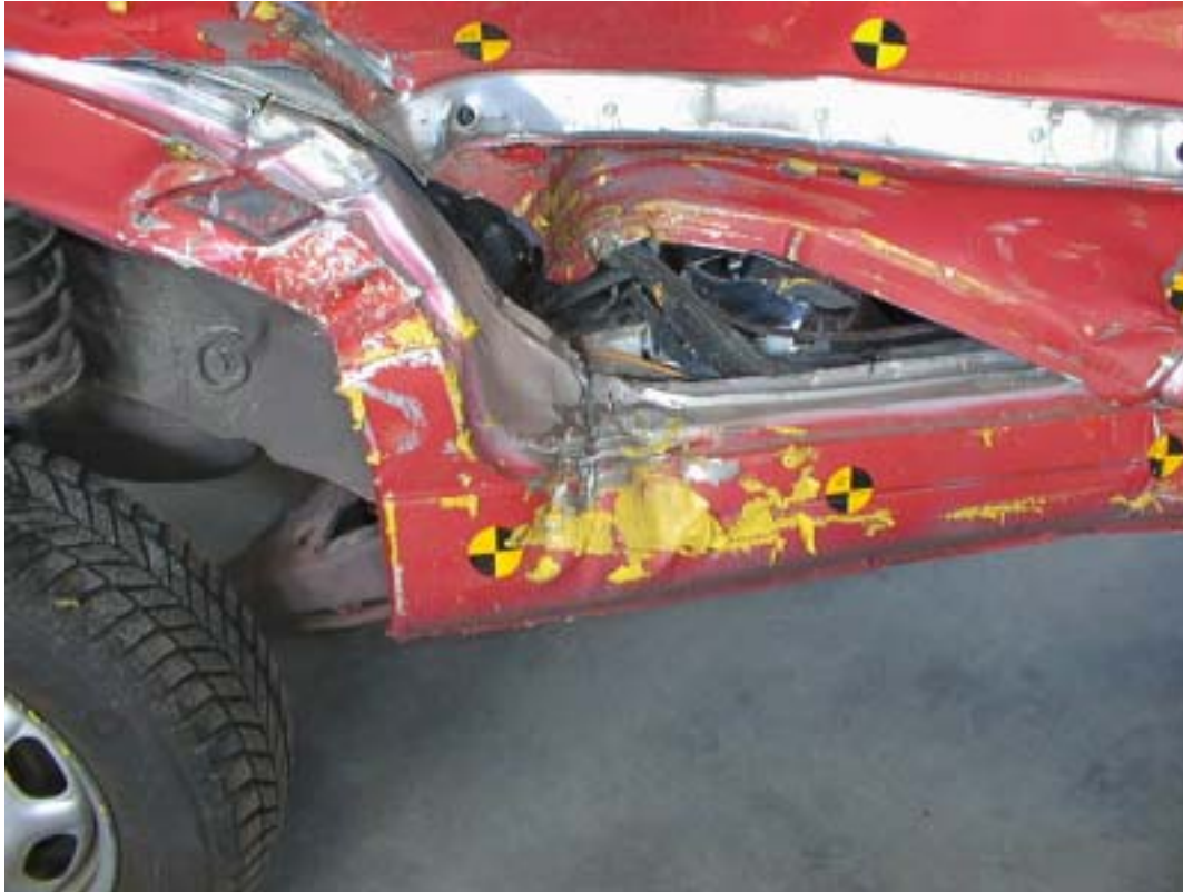
Abbildung 116: Intrusionen VW (Ansicht unterer Türbereich hinten)
