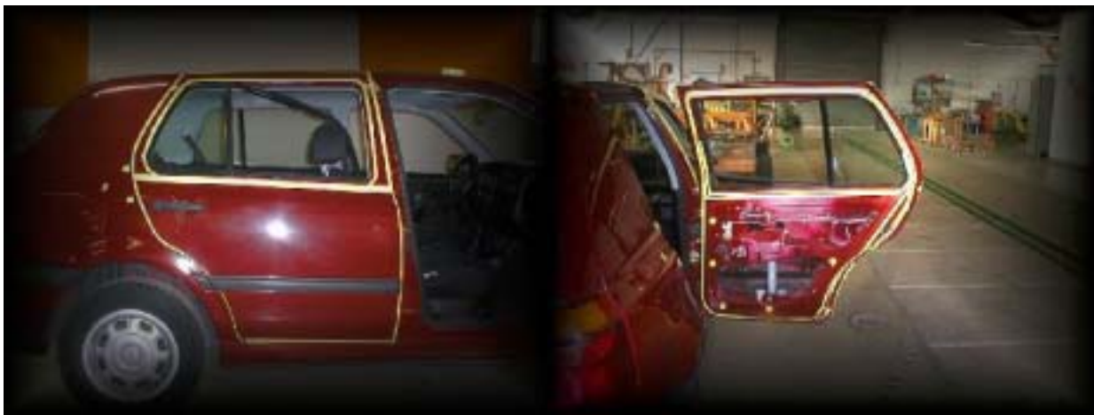
Abbildung 139: Außen- und Innenblech mit Fensterrahmen der Hintertür
