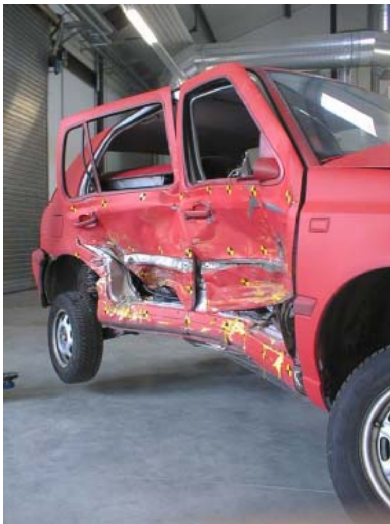
Abbildung 114: Deformationen VW (Ansicht rechts schräg vorne)
