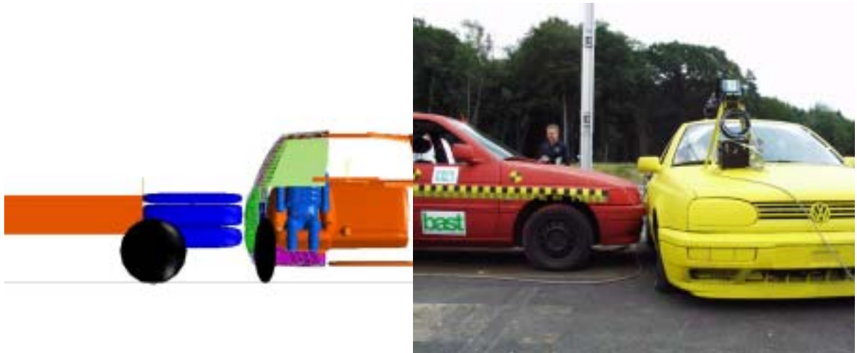
Abbildung 76: Aufprallkonfiguration im Vergleich numerisch / real
