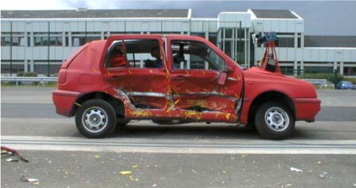
Abbildung 113: Deformationen VW (Ansicht Seite)
