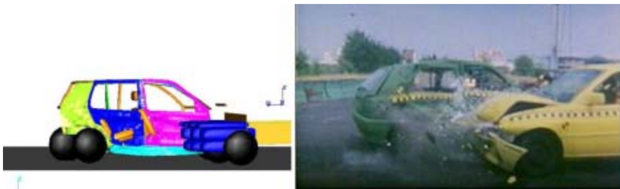
Abbildung 44: 238 Millisekunden nach dem ersten Kontakt zeigen der numerische und der reale Ablauf nahezu gleiche Positionen beider Fahrzeuge
