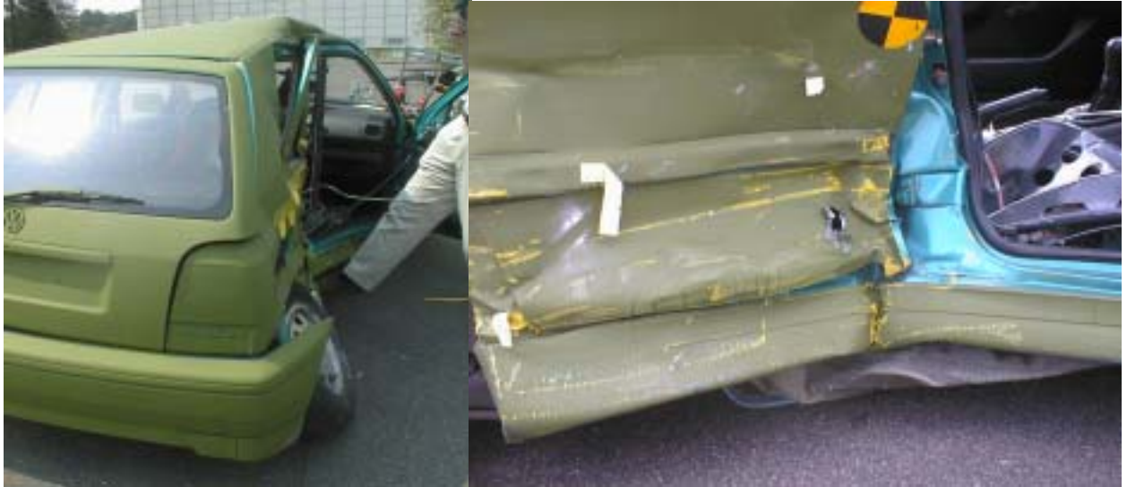
Abbildung 6: Tiefe Intrusionen bei dem gestoßenen Fahrzeug durch geometrische und strukturelle Inkompatibilität im Seitenaufprall
