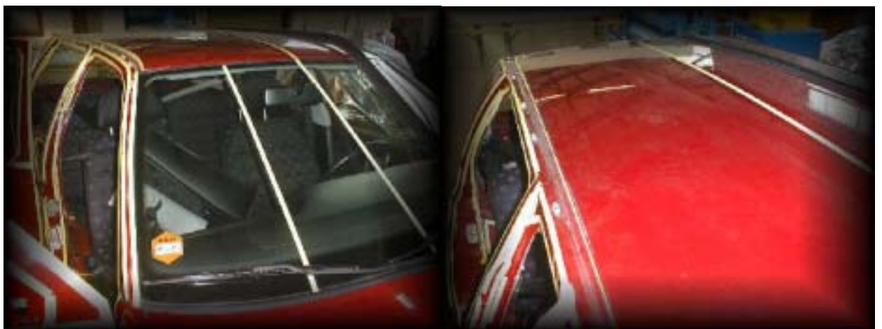
Abbildung 143: A-Säule, Windschutzscheibe, vorderer und hinterer Abschnitt Dach- und Fensterrahmen
