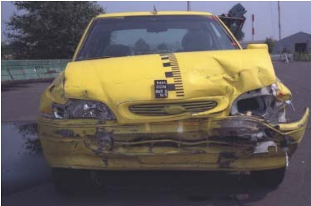
Abbildung 53: Deformationsbild des Ford Escort numerisch (oben) / real (unten)
