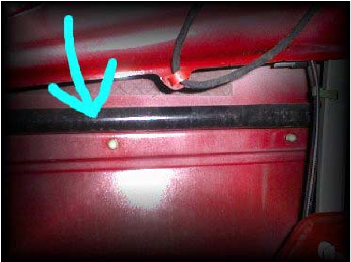
Abbildung 32: Rohre für den Seitenaufprallschutz in beiden Türen
