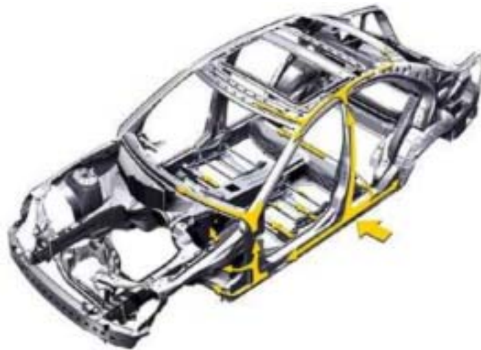
Abbildung 4: Lastpfade in die Karosserie beim Seitenaufprall (Daimler Chrysler)
