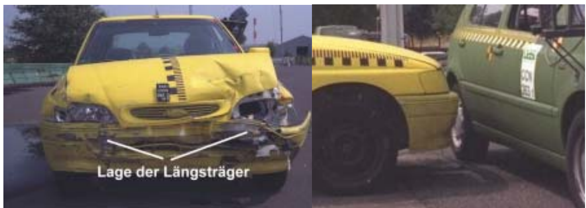
Abbildung 7: Lage des Längsträgers des stoßenden Fahrzeugs und Vergleich mit der Höhe des Seitenschwellers des gestoßenen Fahrzeugs
