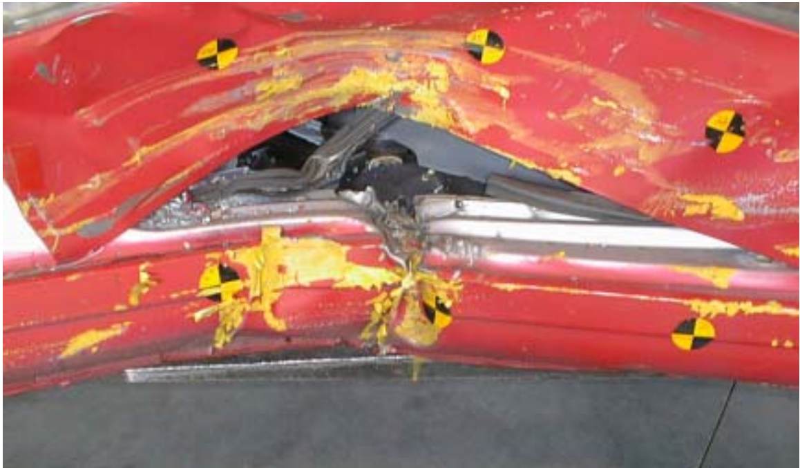
Abbildung 115: Intrusionen VW (Ansicht unterer Türbereich vorne)
