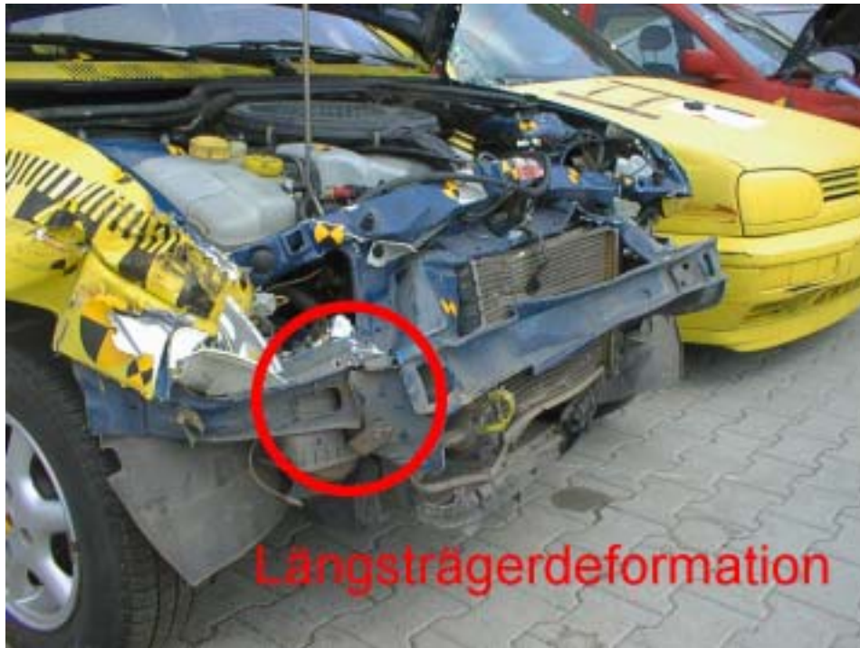
Abbildung 110: Deformation Längsträger rechts
