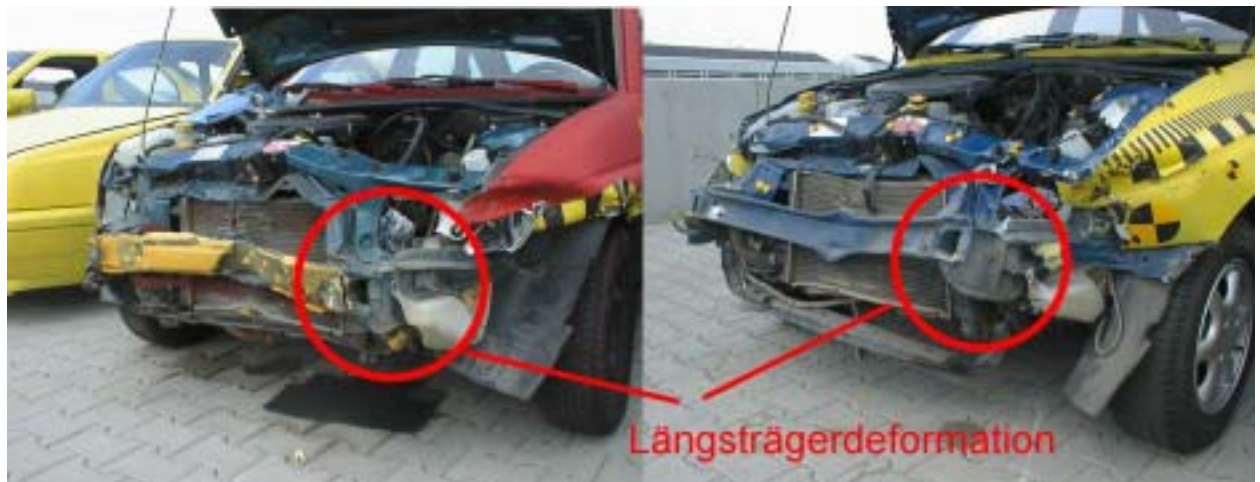
Abbildung 106: Vergleich der Deformationen des Escort ohne (links) und mit (rechts) versteiftem Golf-Seitenschweller.
