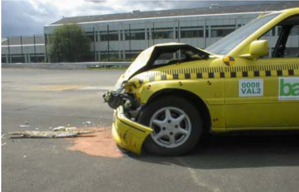
Abbildung 104: Deformationen Ford (Ansicht links)
