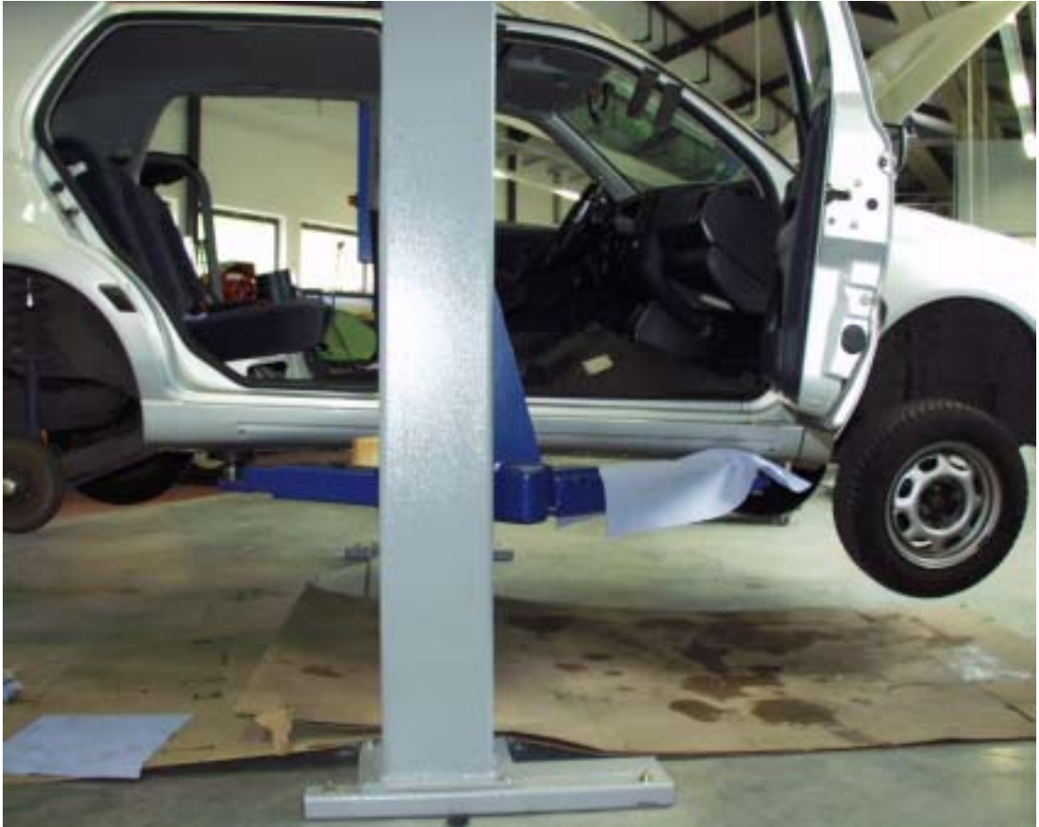
Abbildung 145: Fahrzeugausrichtung beim Schäumen
