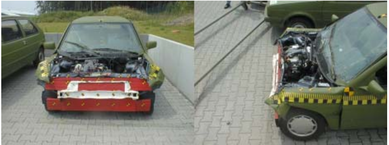
Abbildung 57: Strukturell modifiziertes Fahrzeug zur Erzielung einer homogenen Vorderwagensteifigkeit (/ 11 /)
