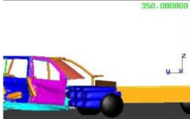
Abbildung 46: Bewegungsablauf numerisch / real bei 200, 250, 300 und 350 Millisekunden
