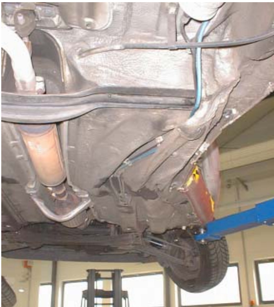
Abbildung 120: Deformation Bodenblech (Ansicht von schräg hinten)
