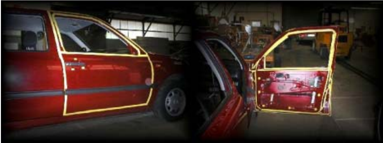
Abbildung 138: Außen- und Innenblech mit Fensterrahmen der Vordertür
