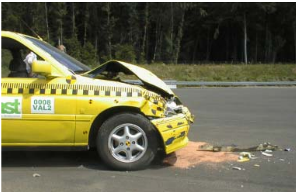
Abbildung 105: Deformationen Ford (Ansicht rechts)
