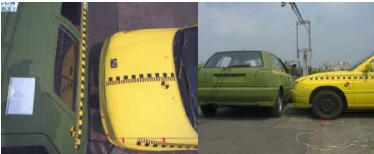
Abbildung 5: Aufprallkonfiguration des Beispiels für Inkompatibilität (CREST-Projekt)
