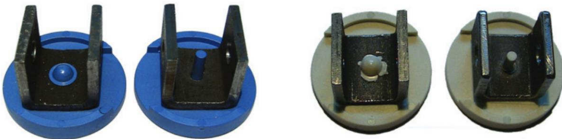
Abbildung 2.7: Genietete Hochtemperaturkunststoffe PEEK und PPS [2.9].
