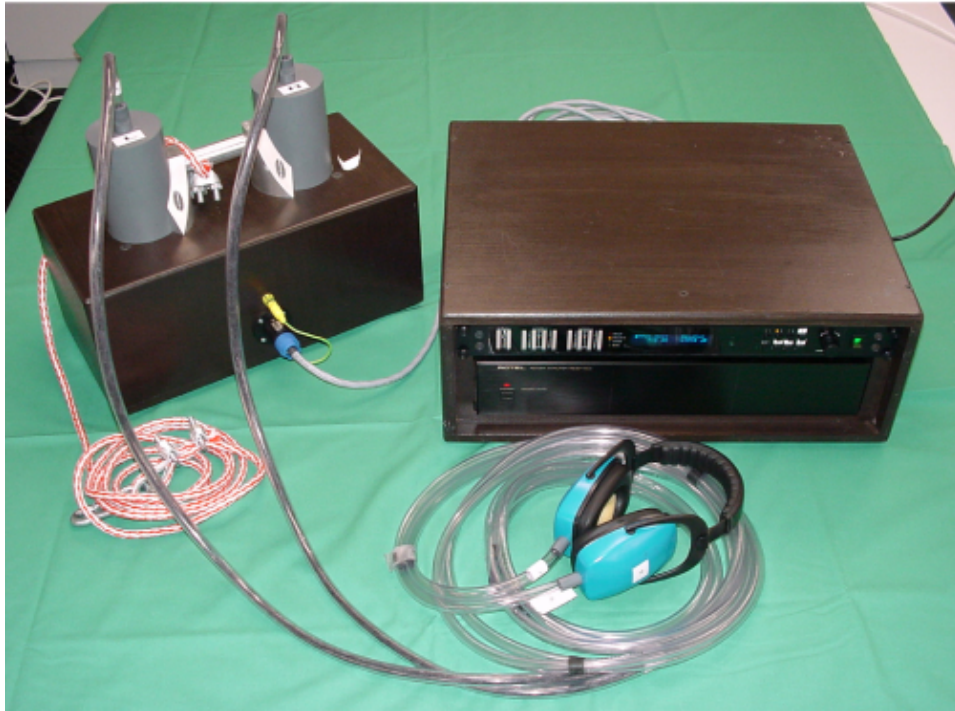
Abbildung A.2: Audioeinspielsystem: Das Bild zeigt das vom Institut für Technische Akustik der RWTH Aachen entwickelte MR-kompatible Audiosystem. Über einen digitalen Filter wird das Frequenzspektrum des eingespielten Signals an das Dämpfungsverhalten des Luftleiters angepasst und bestimmte Frequenzbereiche werden verstärkt. Das so vorbereitete Signal wird über einen Verstärker an zwei leistungsstarke Drucklautsprecher (linker und rechter Kanal) weitergegeben, die das Signal über Luftleiter an den gekapselten Kopfhörer ausgeben. Der Luftleiter und die Kopfhörer sind passiv (ohne magnetische oder elektrische Komponenten) und können ohne Gefahr im starken Magnetfeld des MR betrieben werden. Die rote Sicherheitsleine dient zum Befestigen des Treibermoduls im MR-Raum.
