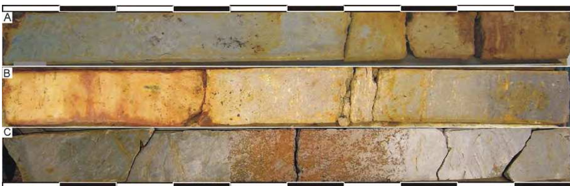
Abbildung 4.22: Präparierte Bohrkerne A) Bohrung SHU 435, Kernmeter 94 bis 95, Sideritmikrokonkretionen zwischen 26 und 62 cm und Toneisenstein (dichter Sideritzement) ab ca. 65 cm; B) Bohrung SHU 435, Kernmeter 95 bis 96 mit Fortsetzung des Toneisensteins als dichter Sideritzement bis 35 cm; C) Bohrung SHU 436, Kernmeter 100 bis 101, durch Sideritmikrokonkretionen zementierter Bereich (Toneisenstein) von 38 bis 69 cm.
