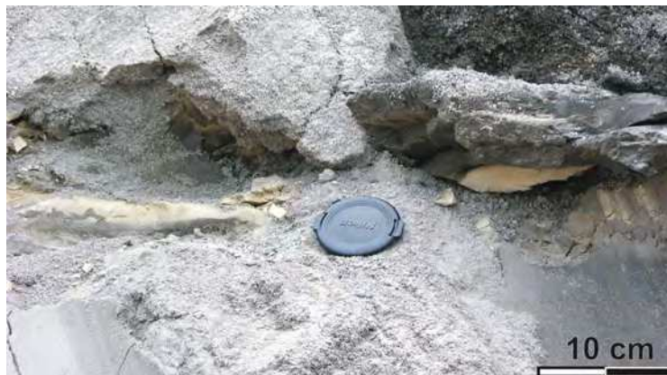
Abbildung 8.14: Teilweise verfestigte, mit Sand überlaufene, Ton/TES-Lage am Top eines Tonhorizontes. Beprobung am 29.06.2010, Profil 9.
