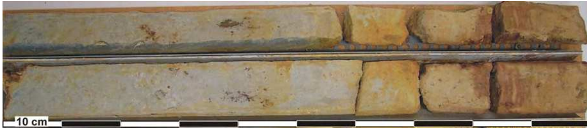
Abbildung 5.3: Bohrung SHU 435, Kernmeter 94 bis 95 mit beiden Bohrkernhälften, Sideritkonkretionen zwischen 20 und 62 cm und Toneisenstein (dichter Sideritzement) ab ca. 65 cm.
