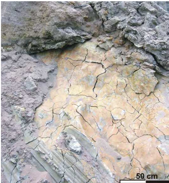
Abbildung 8.13: Großflächige gelblich-rote Eisenoxidüberzüge auf Harnischen. Beprobung am 29.06.2010, Profil 9.
