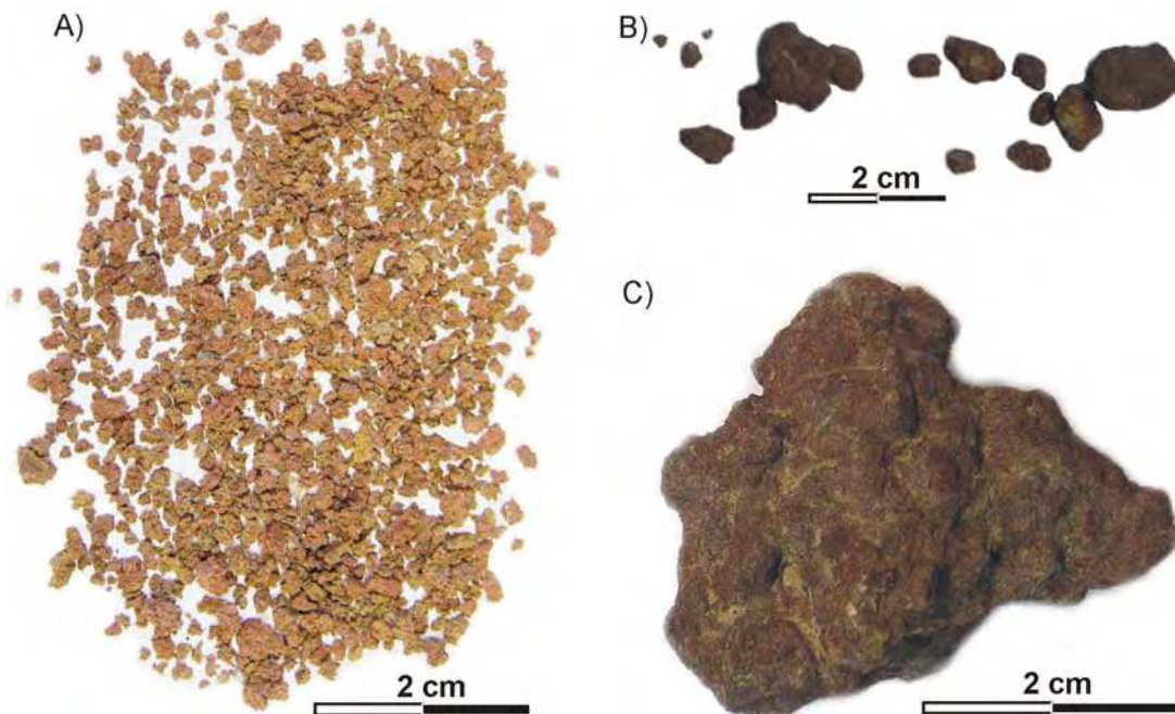
Abbildung 4.15: A) Mikrokonkretionen größer als 1 mm der Tonprobe 33, Profil 3; B) 1 mm bis zu cm große Sideritmikrokonkretionen der Tonprobe 49, Profil 3; C) 4 cm große Sideritkonkretion der Tonprobe 49, Profil 3.
