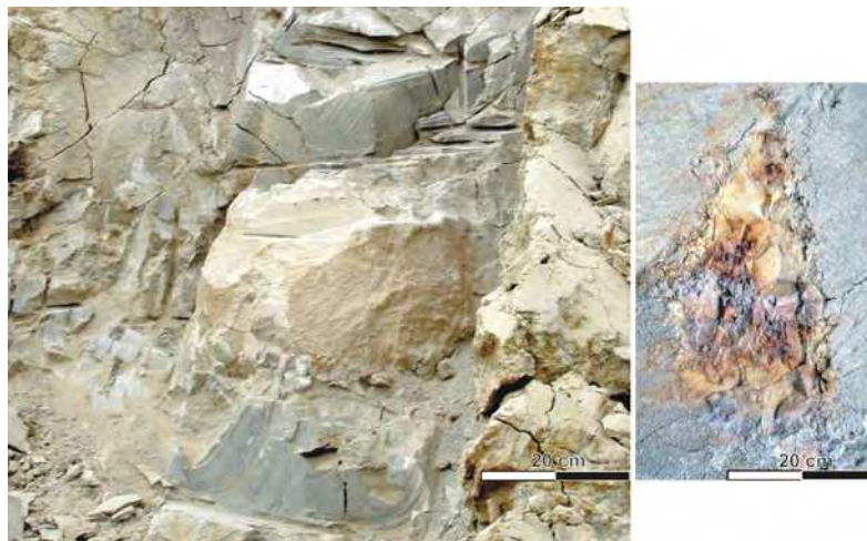
Abbildung 4.21: Links: Toneisenstein-Block. Massig, homogen ausgebildeter, mehrere dm großer, mehr oder weniger runder Toneisenstein im frischen Anschnitt. Rechts: unregelmäßig ausgebildeter, angewitterter Toneisenstein mit teils scharfkantigen Bruchkanten.
