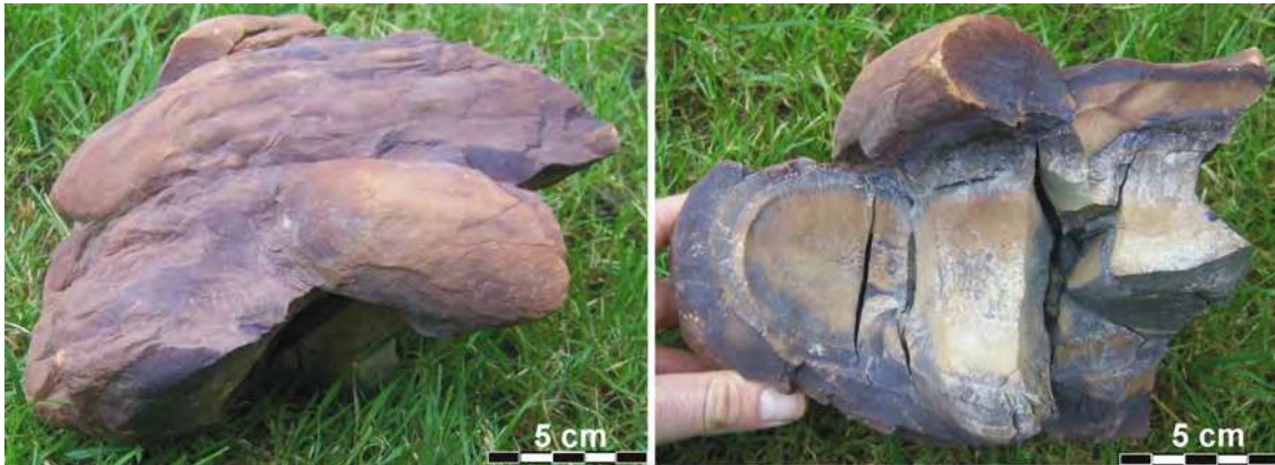
Abbildung 4.20: Toneisenstein-Knolle, unregelmäßig geformte, wulstige Oberfläche und zonierte Aufbau. Untypisch für die Hambacher Toneisensteine sind die Risse/Klüfte im Kern.
