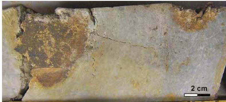
Abbildung 4.17: Präparierter Bohrkern der Bohrung SHU 435: Kernmeter 92 bis 93 mit Toneisenstein-Nestern bei 76 bis 79 cm und 86 bis 82 cm.
