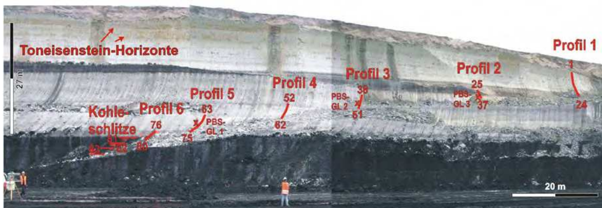
Abbildung 4.4: Probenstelle des Profils 3, Probennahme am 18/19.05.2009: im Liegenden Flöz Garzweiler, darüber Tonhorizont 7A mit humosem Horizont und Toneisenstein-Vorkommen, im Hangenden Sande des Horizontes 7B. Dunkel gefärbte, vertikale Bereiche entstanden durch Wasseraustritte im Hangenden während der Standzeit der Böschung.
