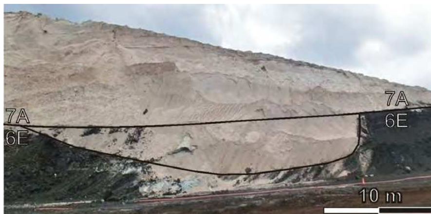
Abbildung 2.7: Sandgefüllte Rinne am Top des Flözes Garzweiler (Horizont 6E) im Süden der 6. Sohle (September 2012).
