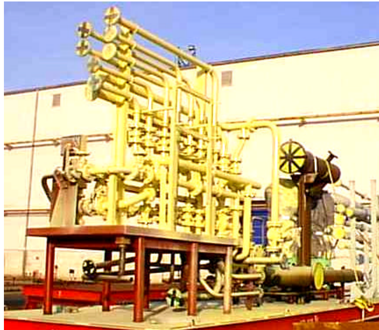
Abbildung 2-4: Rohrpaket für ein Schiffssegment
