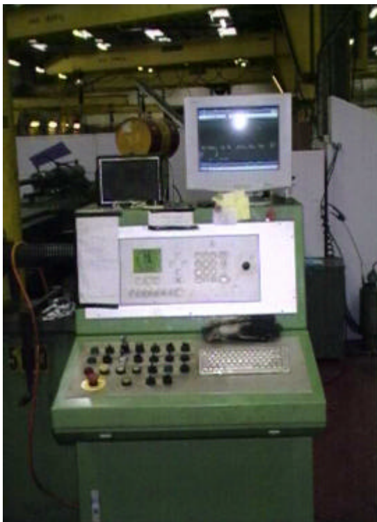
Abbildung 2-12: Installation eines Informationssystems an einer Rohrbiegemaschine
