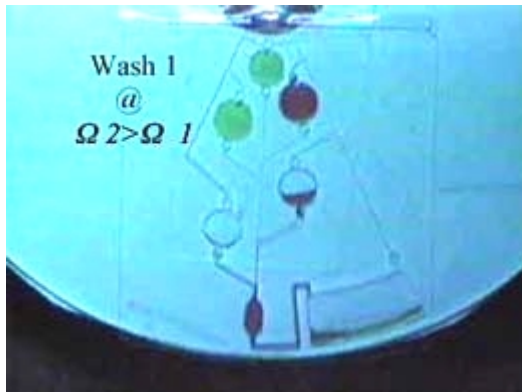
Abbildung 4-1: Flüssigkeitssteuerung durch Zentrifugalkraft (Lab on a CD) [INT1]
