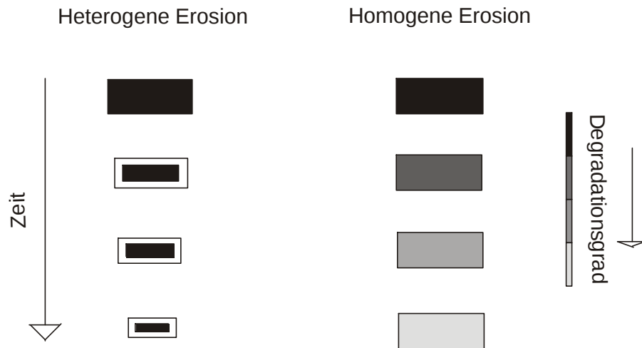
Abb. 3 Schematische Darstellung der Veränderungen einer polymeren Matrix bei homogener und heterogener Erosion 25,23 .
