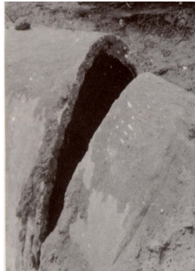
Bild 3.11: Aufgeschwommene Rohrleitung (Gesamtansicht und Detail).
