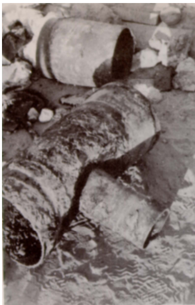
Bild 3.12: Knickversagen und aufgeschwommene Rohrleitung.
