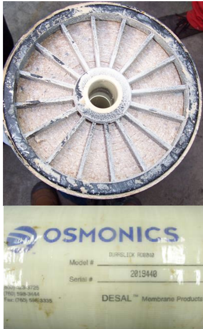
Abbildung 6-70 Duraslick 8040 Modul nach mehr als 11-wöchigem Versuchsbetrieb
