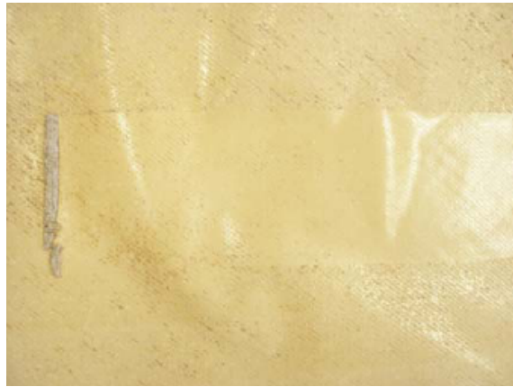
Abbildung 6-72 Membranautopsie: Oberfläche mit abgeschabtem Belag /GE Infrastrukture 2006/
