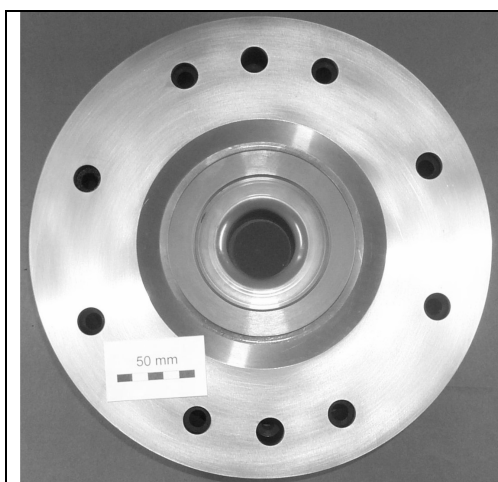
Abb. 6.11: Obergesenk aus \text{Si}_3\text{N}_4
