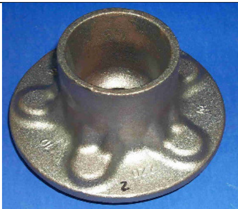
Abb. 6.6: Vereinfachte und verkleinerte Modellradnabe (610 g)
