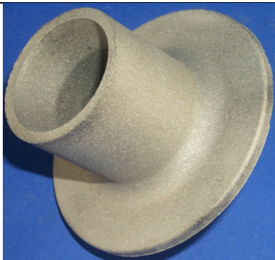
Abb. 6.6: Vereinfachte und verkleinerte Modellradnabe (610 g)
