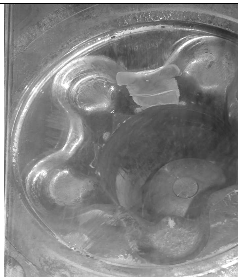
Abb. 7.21: Untergesenek mit einer hohen Biegefestigkeit (Bruch nach 7 Bauteilen)
