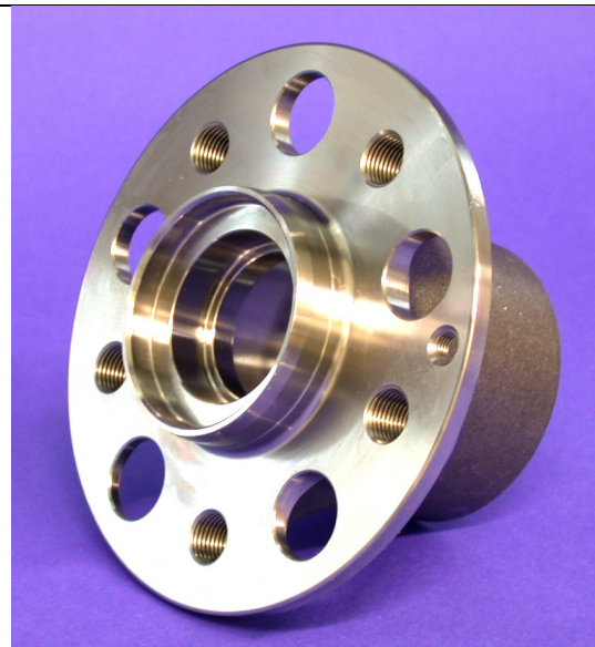
Abb. 3.2: Fertigbauteil nach dem Zerspanen
