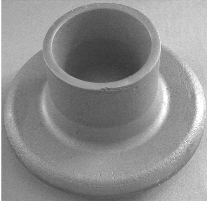
Abb. 8.6: Mit der Methode der gezielten Abkühlung thixogeschmiedete Radnabe (Nr. 34)
