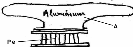
Abb. 2-37 Peltier-Element (Pe) mit aufgeklebten Aluminiumblech (A), von oben
