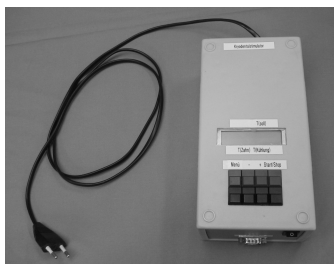
Abb. 2-47 Steuergerät der PE- Pumpeneinheit.
