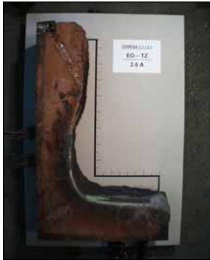
Abb. 7.13 erodiertes L-Profil eisenoxidreicher Beton mit Tonerde-Zement
