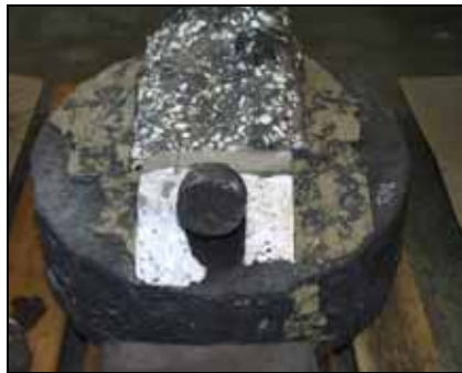
Abb. 7.7 Unterseite des Regulus LCS aus Versuch CORESA 1.1/2.1 - REF
