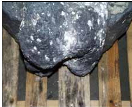
Abb. 7.4 Seitliches Profil des Metallregulus, Versuch CORESA 1.1/2.1 REF (LCS)
