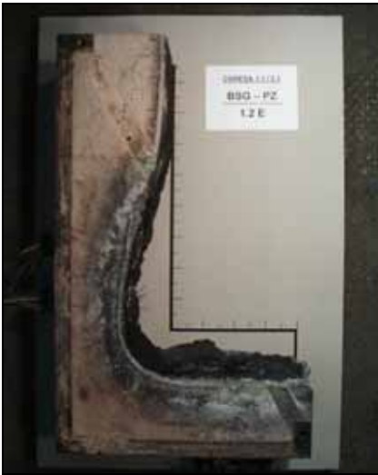
Abb. 7.8 erodiertes L-Profil - BSG - PZ-Beton
