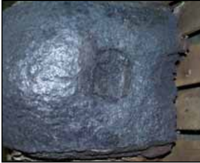
Abb. 7.14 Vertiefungen im Regulus im Versuch CORESA 1.1/2.1 EO-PZ
