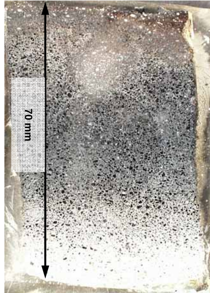
Abb. 6.40 CORESA 3.2, Probe 4a, bis zu 70mm verfestigte Schicht
