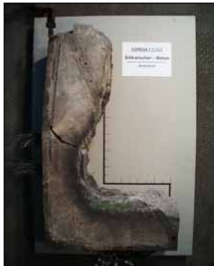
Abb. 7.3 erodiertes L-Profil, silikatischer Beton (SK)
