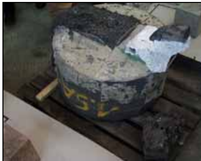
Abb. 7.11 Unterseite des Regulus 1.5A aus Versuch CORESA 1.1/2.1 - BSG- TZ
