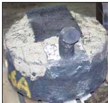
Abb. 7.19 Unterseite des Regulus 2.6a aus Versuch CORESA 1.1/2.1 – EO-TZ
