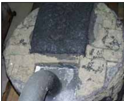
Abb. 7.18 Unterseite des Regulus 2.2b aus Versuch CORESA 1.1/2.1 – EO-PZ
