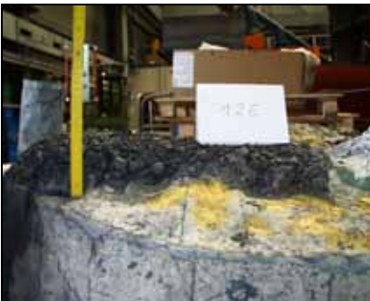
Abb. 7.10 Unterseite des Regulus 1.2E aus Versuch CORESA 1.1/2.1 - BSG- PZ
