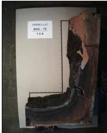
Abb. 7.9 erodiertes L-Profil - BSG - TZ-Beton
