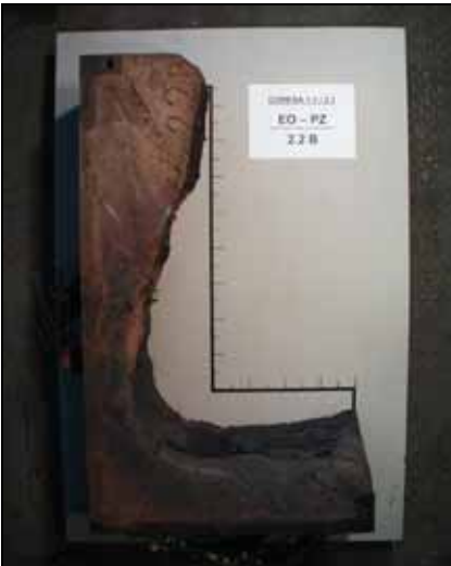
Abb. 7.12 erodiertes L-Profil eisenoxidreicher Beton mit Portland-Zement
