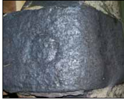
Abb. 7.15 Vertiefungen im Regulus im Versuch CORESA 1.1/2.1 EO-TZ
