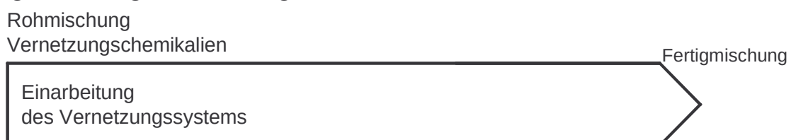
Bild 5-13: Ablauf des Mischprozesses (NR-SBR-BR-Reifenmischung)
