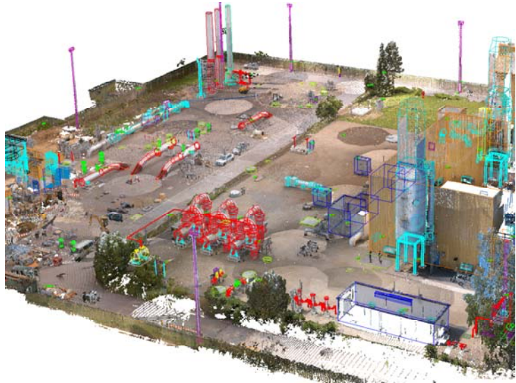
Abbildung 7.6: Darstellung einer auf der Grundlage der Farbdaten aus der photogrammetrischen Aufnahme eingefärbten 3D-Punktwolke mit Überlagerung von CAD-Zeichnungselementen.
