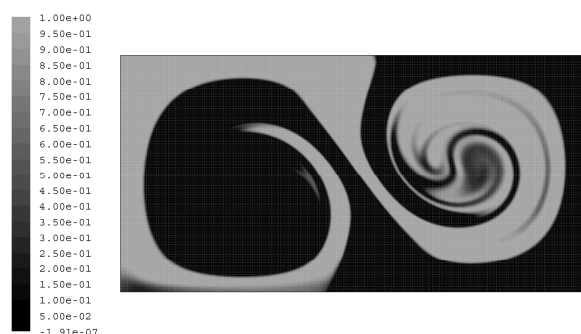
Abb. 10.2 Konzentrationsfeld des Edukts B einer irreversiblen Reaktion 2. Ordnung mit k = 10^5 \text{ m}^3 \text{ mol}^{-1} \text{ s}^{-1} bei z = 1500 \text{ µm} in einem T200-Mikroreaktor bei Re = 186 .
