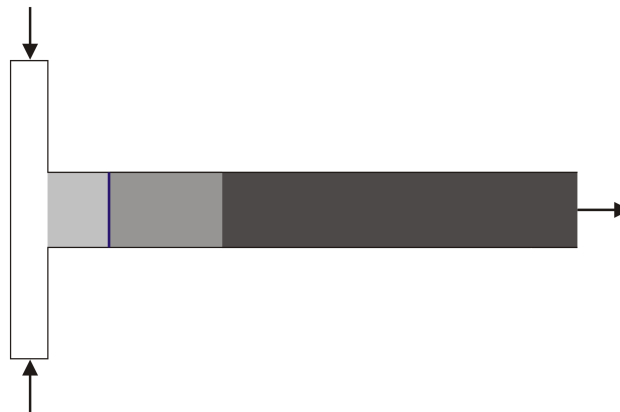
Abb. 5.16 Aufteilung des Mikroreaktors nach den unterschiedlichen Modellansätzen, T200-Mikroreaktor, Re = 186 . Hellgrau und grau: 3-D-Simulationen auf uniformen Gittern zur Gewinnung der Geschwindigkeitsdaten; hellgrau: ausschließlich 3-D-Simulationen der Speziesgleichungen auf partiell verfeinerten Gittern. Blaue senkrechte Linie: Querschnitt, von dem das Startkonzentrationsfeld gewonnen wird. Dunkelgrau: Evolutionsmodell; Bereich, in dem der 2-D-Geschwindigkeitsvektor des Evolutionsmodells aus 3-D-Geschwindigkeitsfelddaten interpoliert wird. Die Pfeile geben die Strömungsrichtung des Fluids an.
