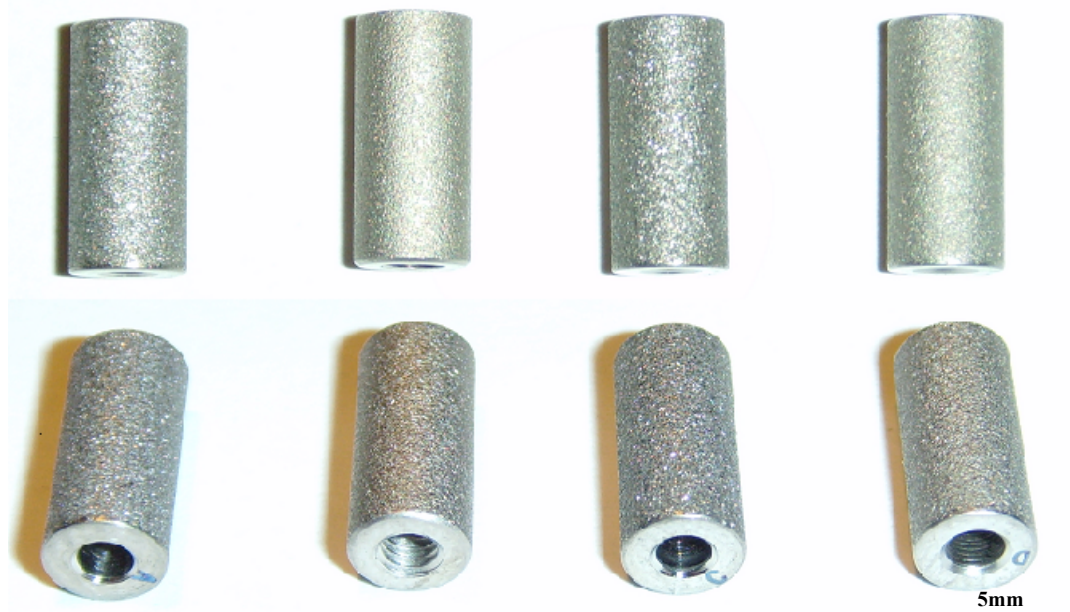
Abb. 8 Alle verwendeten Titanimplantate hatten das gleiche Implantatdesign als Hohlzylinder, aber 4 verschiedene Oberflächen. Bei Typ B und D fällt eine im Vergleich hellere Oberfläche auf, die aus der Befreiung von \text{Al}_2\text{O}_3 -Partikeln mittels ALFREDS resultiert. Bei Typ B (untere Bildhälfte) wird im Hohlzylinder das Gewinde für das Setzinstrument deutlich. Von links: Typ A, Typ B, Typ C, Typ D (3,8fache Vergrößerung)
