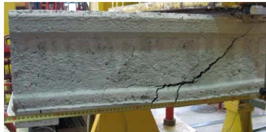
Bild A 2.135: Bruchbilder der Referenzversuche R 5-3 (oben) und R 5-4 (unten) (modifizierte Platten ohne Randkammern)
