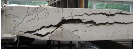
Bild A 2.173: Bruchbilder des Ringankers (links) und der ausgebauten Platte 5 (rechts) in Versuch 8
