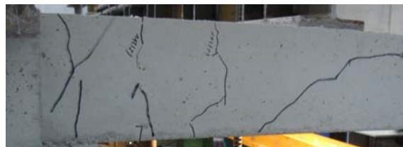
Bild A 2.174: Bruchbild des Ringankers an Platte 6 in Versuch 8 (keine Schubrissbildung der Platte)
