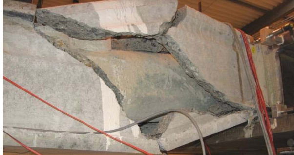
Bild 3.42: Nachträgliche Betonverfüllung einer Platte in Versuch 3 im Bruchzustand
