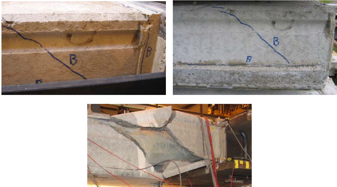
Bild A 2.72: Bruchbilder von Platte 1 (oben) und Platte 10 (unten) in Versuch 3
