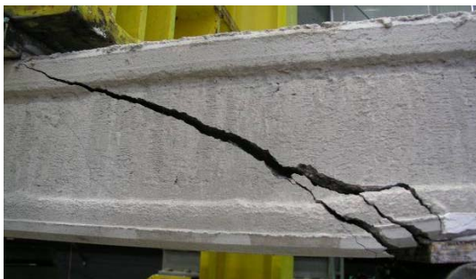
Bild A 2.116: Bruchbilder der Referenzversuche R 4-1 (oben) und R 4-2 (unten)
