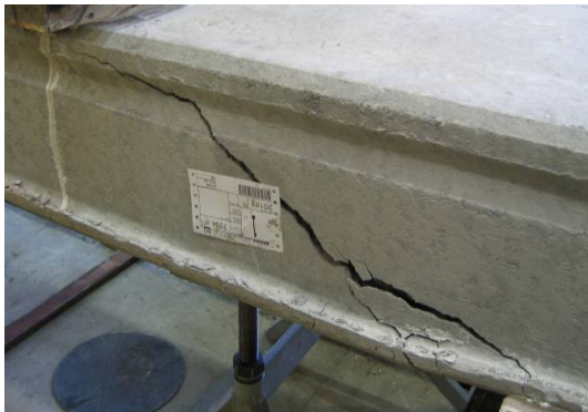
Bild A 2.93: Bruchbilder der Referenzversuche R 3-1 (oben) und R 3-2 (unten)
