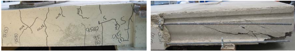
Bild A 2.155: Bruchbilder des Ringankers (links) und der ausgebauten Platte 1 (rechts) in Versuch 7
