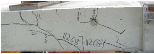
Bild A 2.172: Bruchbilder des Ringankers (links) und der ausgebauten Platte 1 (rechts) in Versuch 8
