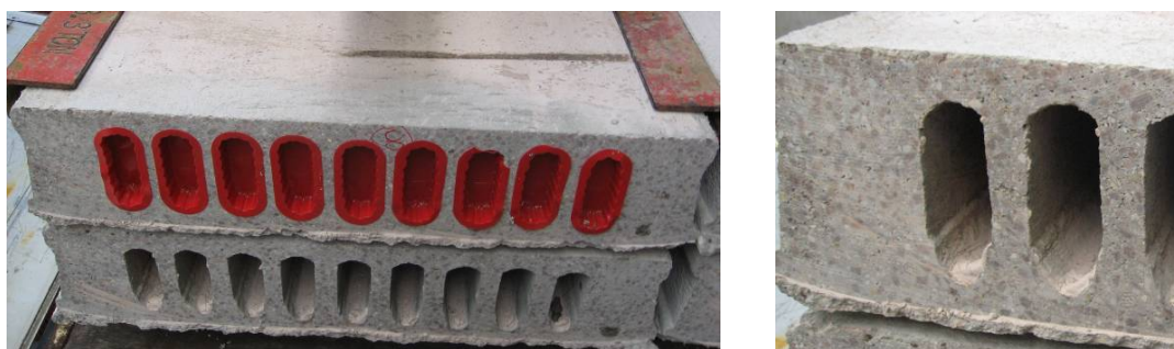
Bild 3.14: Modifizierter Plattenquerschnitt VMM VSD 25 ohne Randkammern
