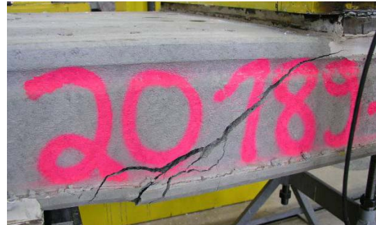
Bild A 2.32: Bruchbilder der Referenzversuche R 1-1 (oben) und R 1-2 (unten)
