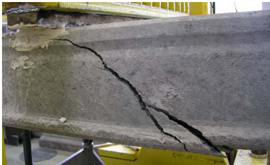
Bild A 2.32: Bruchbilder der Referenzversuche R 1-1 (oben) und R 1-2 (unten)
