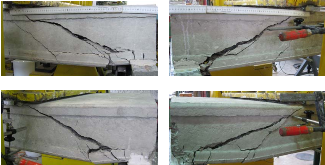
Bild A 2.187: Bruchbilder der Referenzversuche R 8-1 (oben) und R 8-2 (unten)
