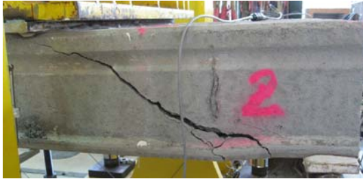
Bild A 2.152: Bruchbilder der Referenzversuche R 6-3 (oben) und R 6-4 (unten) (modifizierte Platten mit werkseitiger Kammervorfüllung)
