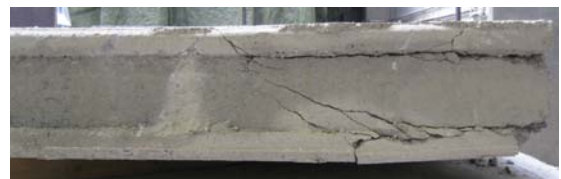
Bild A 2.175: Bruchbilder des Ringankers (links) und der ausgebauten Platte 10 (rechts) in Versuch 8
