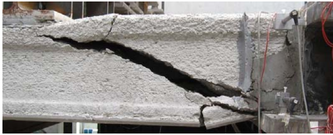
Bild A 2.119: Bruchbild von Platte 10 in Versuch 5
