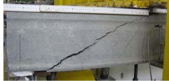
Bild A 2.152: Bruchbilder der Referenzversuche R 6-3 (oben) und R 6-4 (unten) (modifizierte Platten mit werkseitiger Kammervorfüllung)
