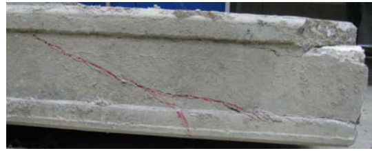
Bild A 2.172: Bruchbilder des Ringankers (links) und der ausgebauten Platte 1 (rechts) in Versuch 8
