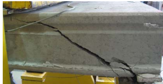
Bild A 2.151: Bruchbilder der Referenzversuche R 6-1 (oben) und R 6-2 (unten)
