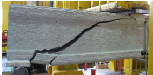
Bild A 2.134: Bruchbilder der Referenzversuche R 5-1 (oben) und R 5-2 (unten)
