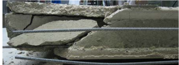
Bild A 2.173: Bruchbilder des Ringankers (links) und der ausgebauten Platte 5 (rechts) in Versuch 8
