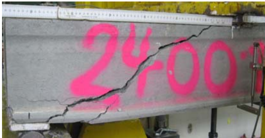
Bild A 2.151: Bruchbilder der Referenzversuche R 6-1 (oben) und R 6-2 (unten)
