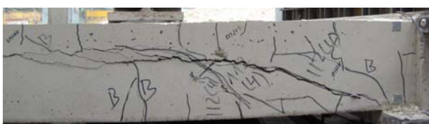
Bild A 2.175: Bruchbilder des Ringankers (links) und der ausgebauten Platte 10 (rechts) in Versuch 8
