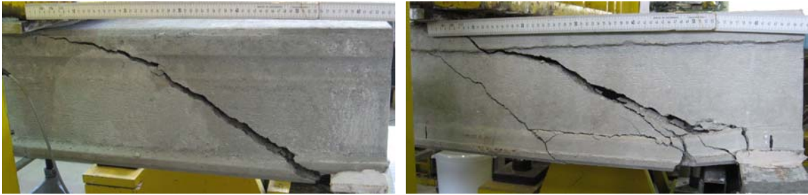
Bild 3.29: Bruchbilder der Referenzversuche R 6-1 (links, Platte MV5/265) und R 8-1 (rechts, Platte VMM VSD 25)
