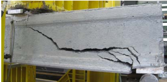
Bild A 2.134: Bruchbilder der Referenzversuche R 5-1 (oben) und R 5-2 (unten)
