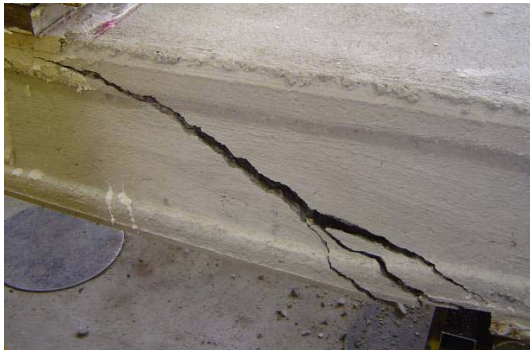
Bild A 2.69: Bruchbilder der Referenzversuche R 2-1 (oben) und R 2-2 (unten)
