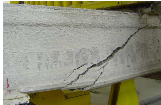
Bild A 2.69: Bruchbilder der Referenzversuche R 2-1 (oben) und R 2-2 (unten)
