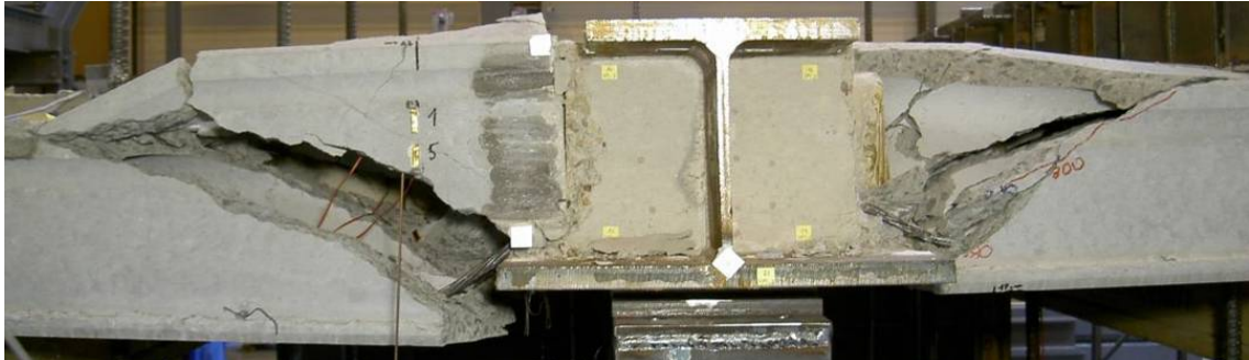
Bild A 2.8: Bruchbild von Platte 10 (Versuch 1-b, links) und Platte 5 (Versuch 1-a, rechts)
