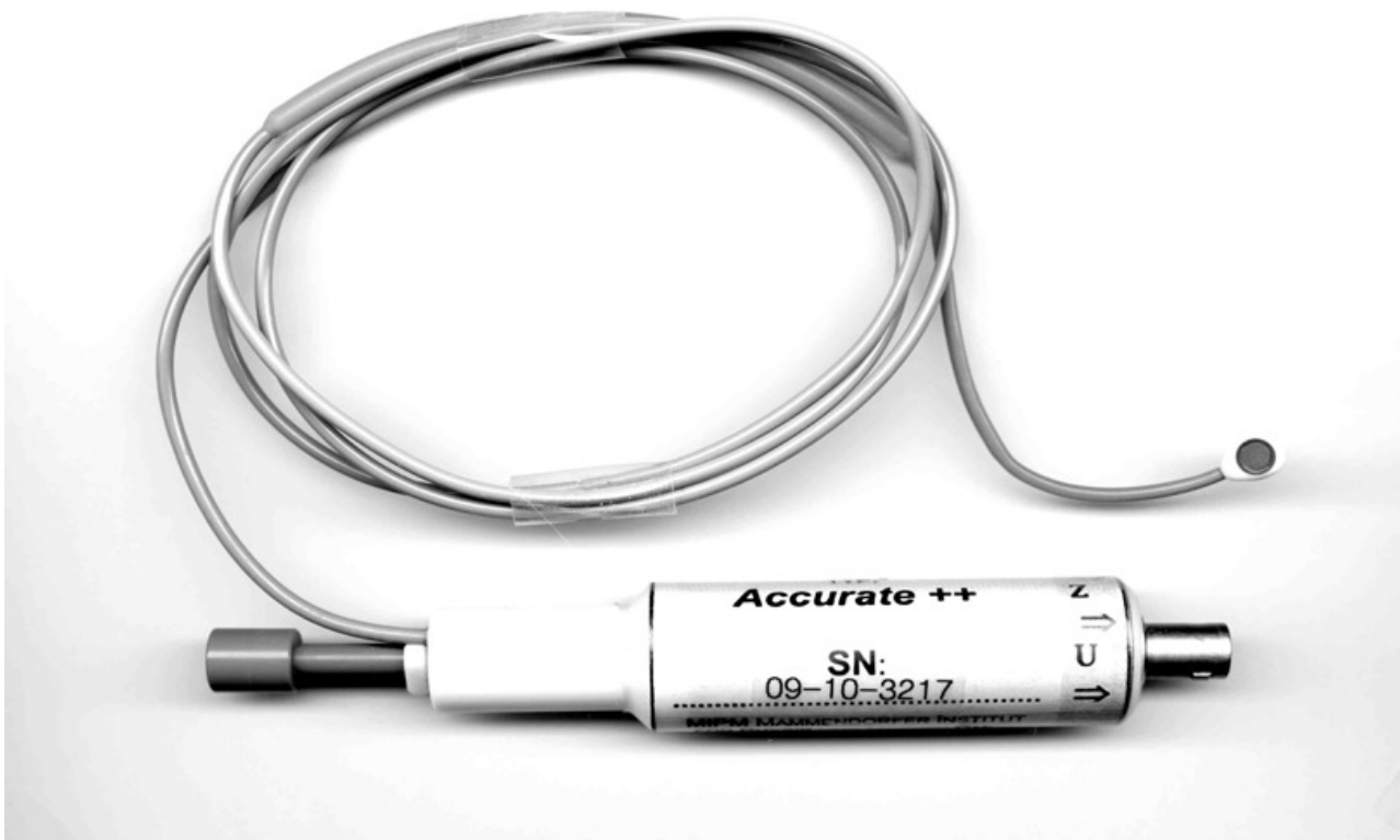
Abbildung 2: Sonde (Accurate++®, MIPM, Mammendorf, Deutschland) zur piezoresistiven Manometrie (PRM). Diese Sonde wird an einen Druckaufnehmer angeschlossen (Sirecust404®, Siemens, Deutschland). Die Sonde kann während des Gebrauchs mit dem Umgebungsdruck abgeglichen werden. Sie kann resterilisiert und damit wieder verwendet werden. Die Kosten für eine Messsonde betragen etwa 2800 Euro.
