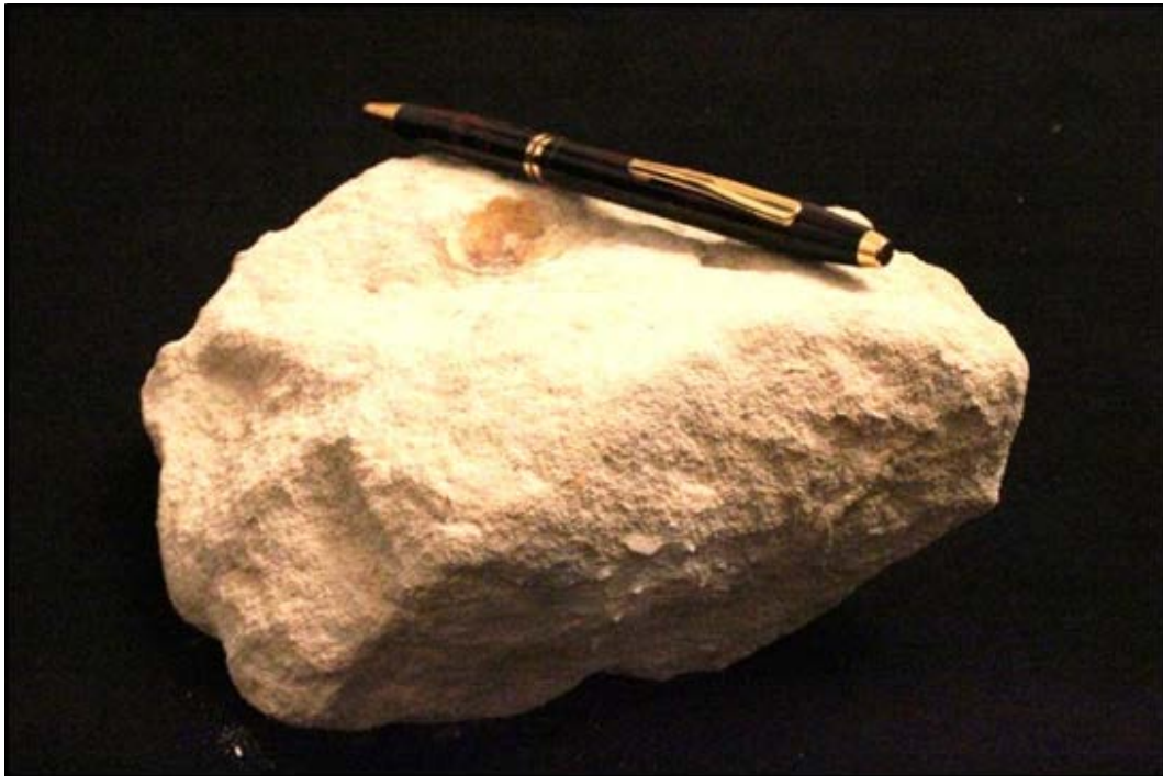
Abb. 19: Typisches Handstück der Maastrichter Kreide mit einer fossilen Muschel von ca. 2 cm Durchmesser (Van Aaken 2013).
