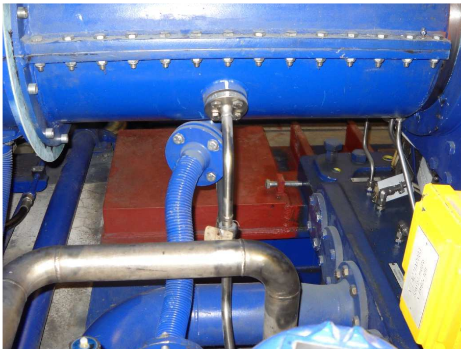
Abbildung 5-2: Hinzufügen von Zusatzgewicht in Form einer Stahlplatte
