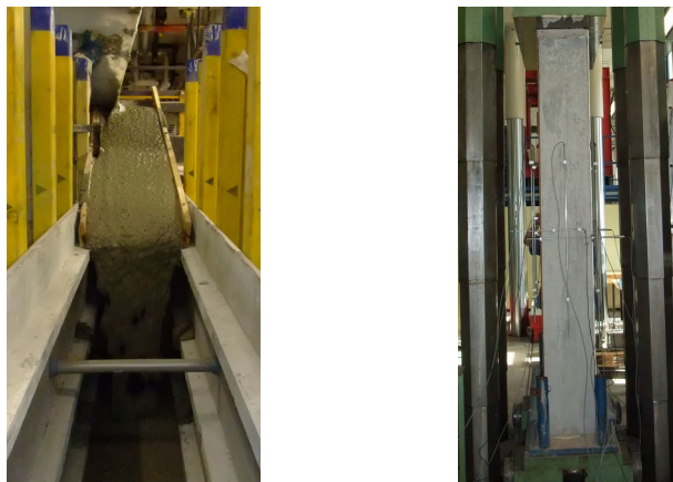
Bild 3: Aufbau der Schalung (links) und Wandprüfung (rechts)
