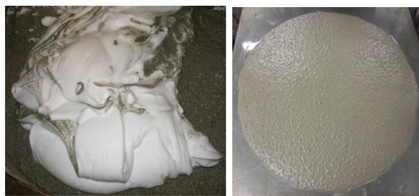
Bild 2: Zugabe des Schaums (links) und Setzfließmaß (rechts)
