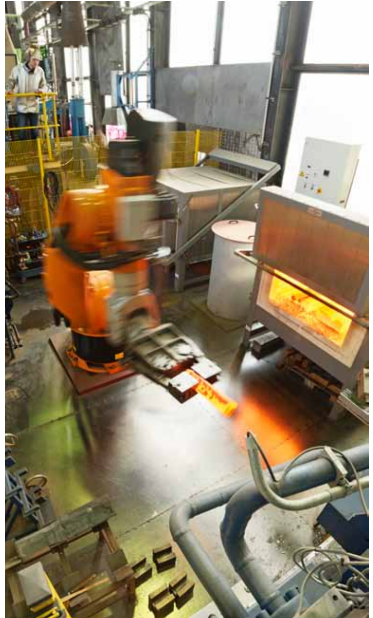
Bild 2-4: Automatisierte Werkstoffverarbeitung am Semi-Product Simulation Center. Gussblöcke werden mittels Roboter und Schmiedepresse zu Vierkantstangen als Vormaterial für die weitere Werkstoffcharakterisierung verarbeitet. Fotos: Peter Winandy
