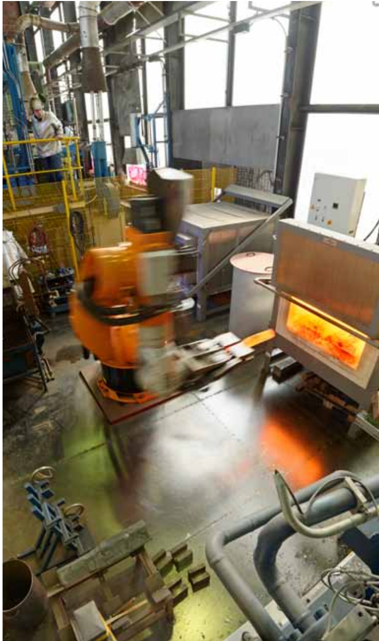
Bild 2-4: Automatisierte Werkstoffverarbeitung am Semi-Product Simulation Center. Gussblöcke werden mittels Roboter und Schmiedepresse zu Vierkantstangen als Vormaterial für die weitere Werkstoffcharakterisierung verarbeitet. Fotos: Peter Winandy
