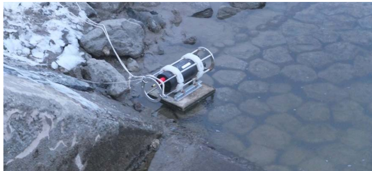
Abbildung 5.3: Valeport Midas CTD-Sonde im Außenbereich des Sieltores Osterwehl während Tideniedrigwasser
