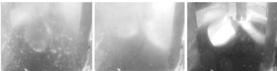
Abbildung 5.16: Fotos der Trübung während der Messung an Messpunkt P3; links: Propeller noch in Ruhe; Mitte: Beginn der Propellerdrehung; rechts: gegen Ende der Messung
