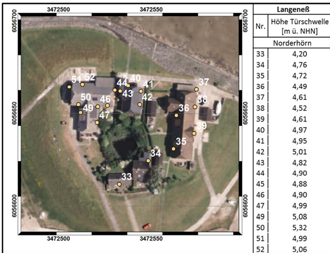
Abbildung D 6: Positionen der Türschwellen auf Norderhörn/Langeneß und ihre Höhen in Meter über NHN
