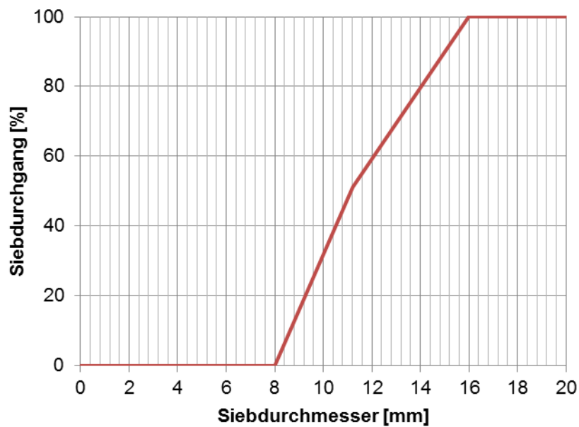
Abbildung 4.11: Sieblinie der verwendeten Gesteinskörnung
