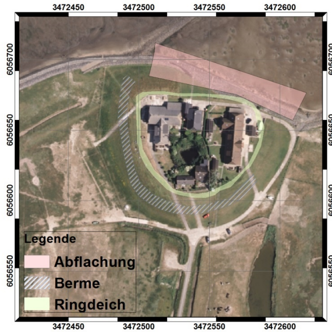
Abbildung E 2: Schematische Darstellung der vorgeschlagenen Warftverstärkungsmaßnahmen für Norderhörn
