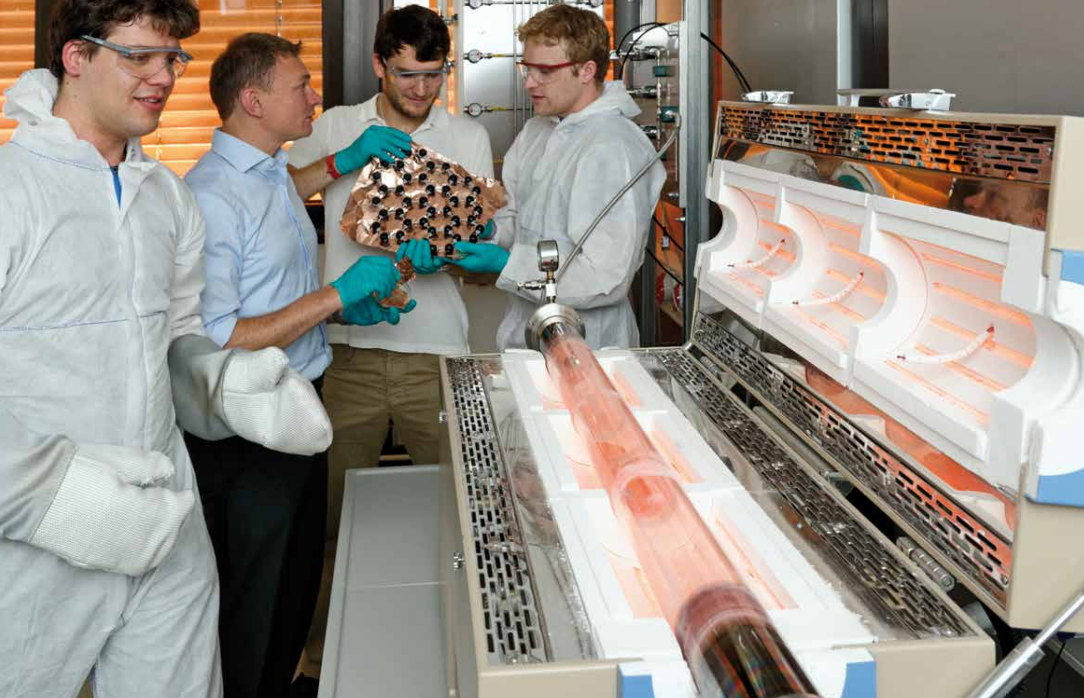
Professor Christoph Stampfer und seine Mitarbeiter vom II. Physikalischen Institut an einem geöffneten CVD-Ofen. Der Ofen dient zum Wachsen von Graphen auf Kupferfolie bei 1.000 Grad Celsius.
