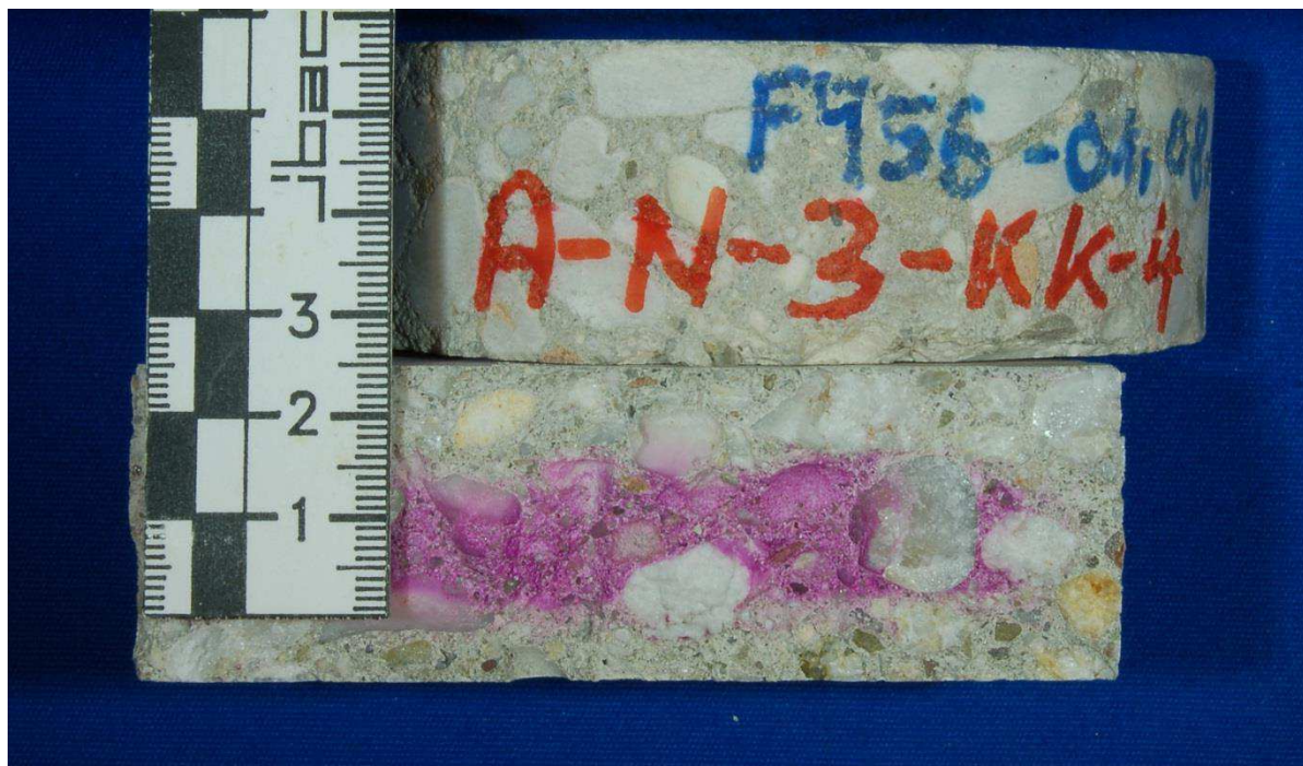
Abbildung 3-16: Farbgebung nach Besprühen der Bruchfläche mit Phenolphthaleinlösung (Probekörper: A-N-3-KK-4)
