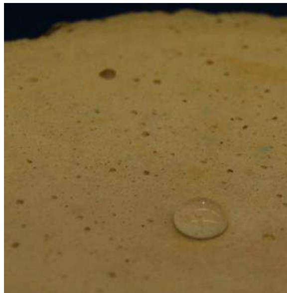
Abbildung 4-34: Wassertropfen auf Probekörperoberfläche (Beton B) nach 2 monatiger Exposition
