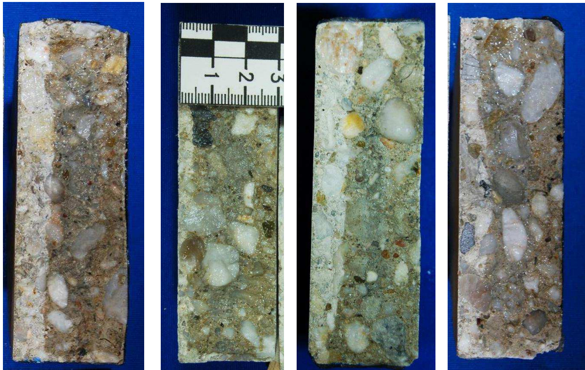
Abbildung 4-21: Erscheinungsformen der hydrophoben Schicht nach Bruchflächensprühtests; links: konstant dick; Mitte links: konstant dünn; Mitte rechts: schräg; rechts: wellig
