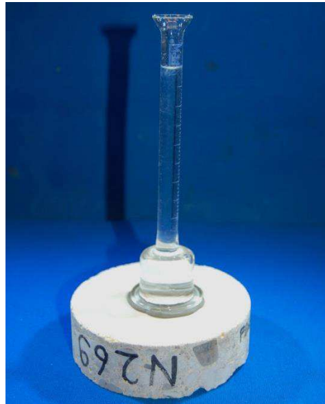
Abbildung 3-12: Probekörper mit Karstenschem Röhrchen für horizontale Flächen
