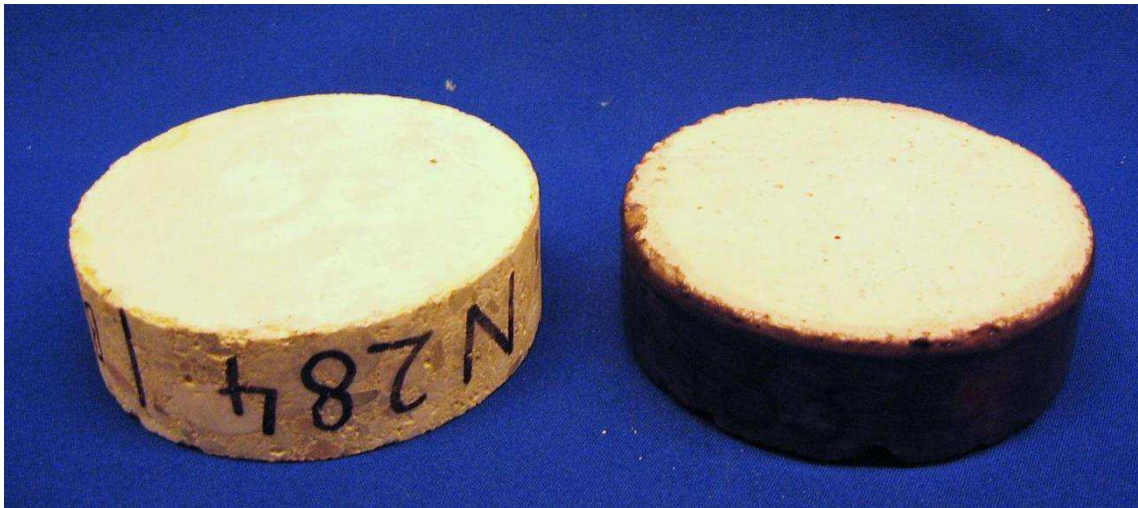
Abbildung 3-8: Probekörper vor (links) und nach (rechts) der Versiegelung des Seitenrandes
