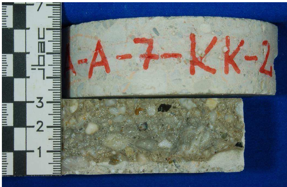
Abbildung 3-14: Farbgebung nach Besprühen der Bruchfläche (Probekörper: A-A-7-KK-2)
