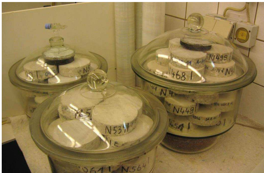
Abbildung 3-2: Probekörper gelagert in Glasexsikkatoren zur Trocknung unter Ausschluss von \text{CO}_2
