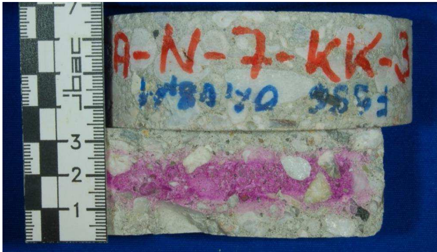
Abbildung 4-28: Karbonatisierungstiefenbestimmung an einem Probekörper der Versuchsreihe Karbonatisierung, Beton A, Hydrophobierung 7 (A-N-7-KK-3) nach 2 Monaten Lagerung bei 2 Vol.-% \text{CO}_2
