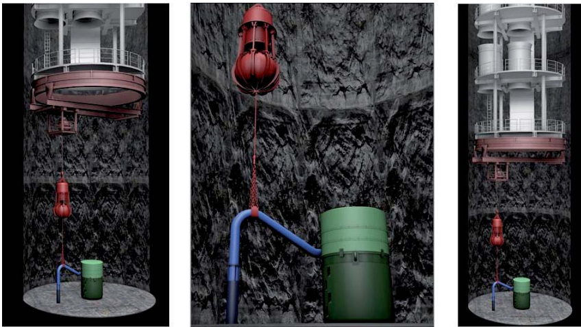
Abbildung 76: Saugschlauchführung mit Hilfe des Greifers. 203
