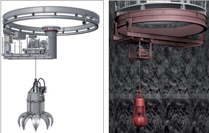
Abbildung 31: Verschiedene Konstruktionsbeispiele von Greiferbühnen. 137, 138
