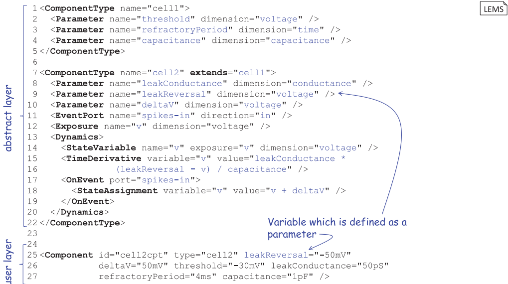
Abbildung 3.4: Ein einfaches Integrate-and-Fire Modell als LEMS Model [lem17]. Die Vererbungsbeziehung zwischen cell11 und cell12 erlaubt die Benutzung von Parametern in cell11 im cell12 -Neuron.
