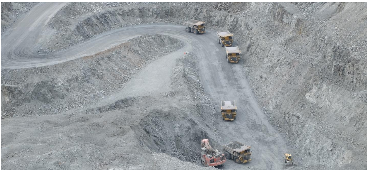
Abbildung 33: Diskontinuierlicher Beladungsvorgang eines SKW mit einem Hochlöfflbagger
