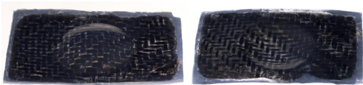
Abbildung 5.18: Mithilfe der Ultraschallfertigung hergestelltes dreidimensionales Bauteil bestehend aus Kohlenstofffasergewebe mit einer Dicke von 450\ \mu\text{m} sowie zwei 80\ \mu\text{m} dicken und zwei 160\ \mu\text{m} dicken PA6-Folien [13].
