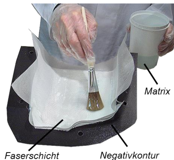
Abbildung 2.16: Herstellung von GFK-Bauteilen mittels Handlaminieren [28].
