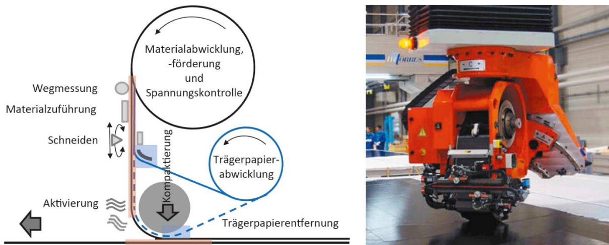
Abbildung 2.11: Links: Schematische Darstellung des Tapelegevorganges. Rechts: Ein an einem Portalkran befestigter Kopf einer Tapelegeanlage [1].
