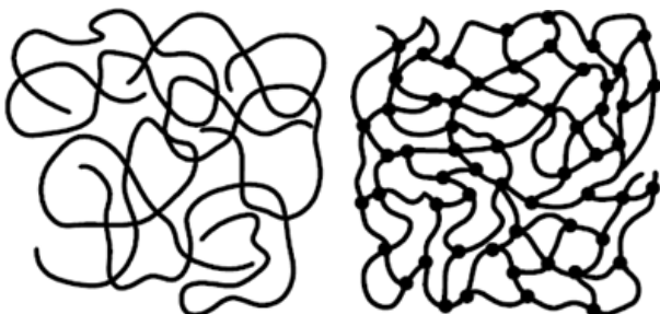
Abbildung 2.3: Molekülkettenstruktur von Polymeren: Verschlaufte Thermoplast (links), vernetzter Duroplast (rechts) [13].
