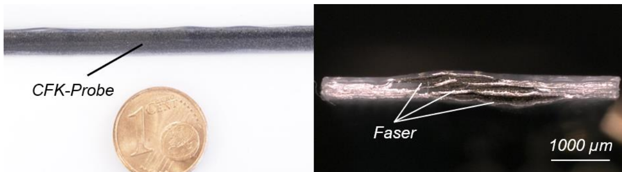
Abbildung 5.7: In der Versuchsanordnung 3 hergestellte CFK-Probe aus vier Lagen PE-Folien mit einer Dicke von jeweils 150\ \mu\text{m} sowie drei Lagen 3 K Fasern mit einer Dicke von jeweils ca. 50\ \mu\text{m} . Die Gesamtdicke der Probe betrug ca. 690\ \mu\text{m} . Links ist die Draufsicht und rechts ein Schnitt quer zur Faserlängsrichtung zu sehen.
