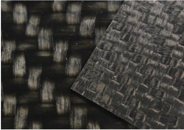
Abbildung 4.51: CFK-Platten aus konventioneller Fertigung (links) sowie der Ultraschallfertigung (rechts).
