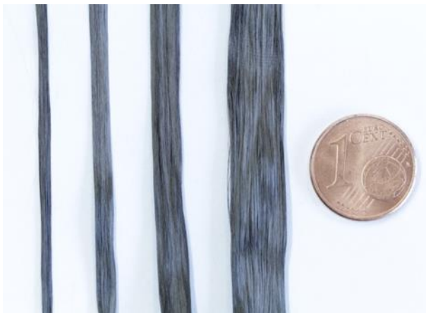
Abbildung 5.3: Aus 3.000 bis 24.000 Einzelfasern bestehende Kohlenstofffasern.
