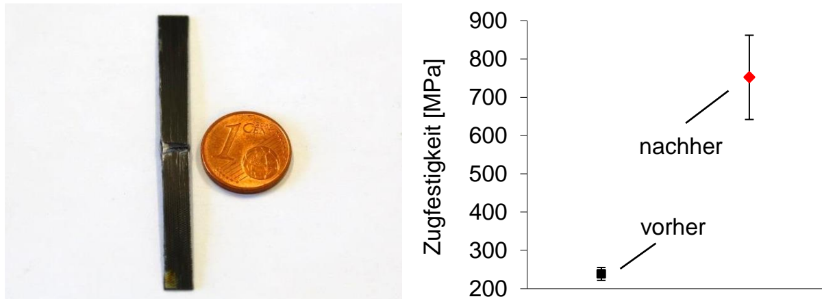
Abbildung 4.22: Links: Mittels Ultraschall hergestellte CFK-Probe nach dem Zugversuch. Rechts: Im Zugversuch gemessene mittlere Zugfestigkeiten sowie die zugehörigen Standardabweichungen vor und nach der Optimierung des Herstellungsprozesses. Es wurden 20 („vorher“) sowie 5 („nachher“) CFK-Proben untersucht.
