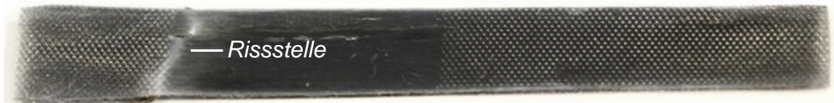
Abbildung 4.12: CFK-Proben nach dem Zugversuch mit Darstellung der Rissstelle bei gleichmäßiger (oben) und ungleichmäßiger Einspannung (unten) [7].
