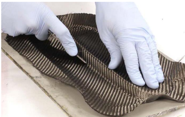
Abbildung 2.9: Handlaminieren eines CFK-Prepregs [22].
