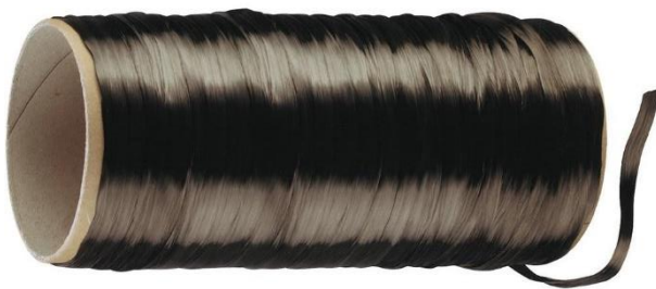
Abbildung 2.5: Roving mit Endlosfasern aus Kohlenstoff [17].
