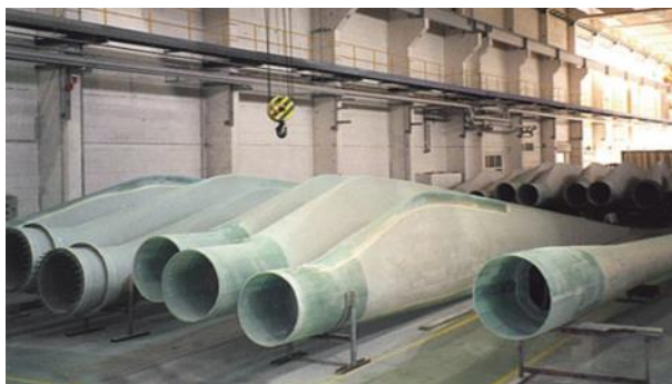
Abbildung 2.6: Rotorblätter einer Windkraftanlage aus GFK [18].
