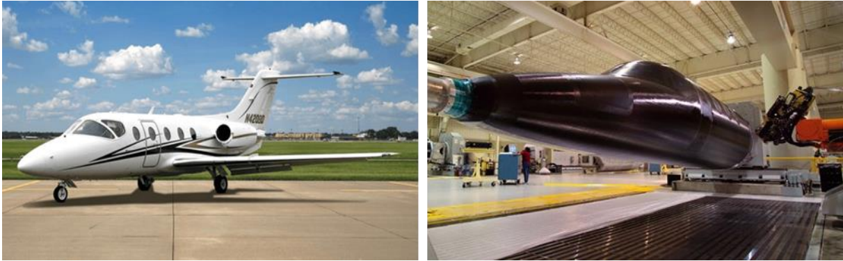
Abbildung 2.10: Kleinflugzeug Hawker 400XP des US-amerikanischen Herstellers HAWKER BEECHCRAFT (links) sowie dessen mithilfe von Tapelegen hergestellte CFK-Struktur (rechts) [23,24].
