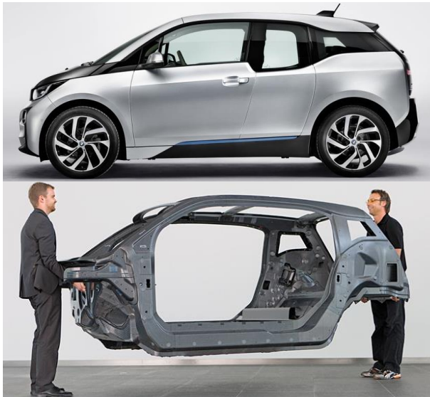
Abbildung 3.1: Der elektrische Kleinwagen BMW i3 (oben) sowie seine Karosserie aus CFK (unten) [48,48].
