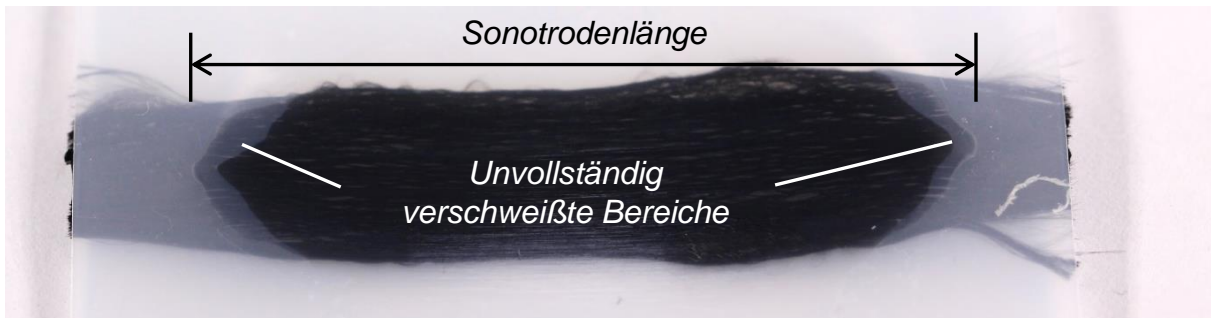
Abbildung 4.6: Darstellung einer ultraschallverschweißten CFK-Probe sowie eingezeichnete Länge der zur Herstellung verwendeten Sonotrode mit den Abmessungen von 60 mm x 40 mm [7].
