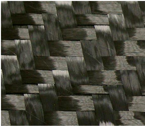
Abbildung 4.47: Detailaufnahme eines Kohlenstofffasergewebes. Die Breite der sich in 0°- und 90°-Richtung kreuzenden Faserbündel beträgt typischerweise zwischen 1 und 5 mm [62].
