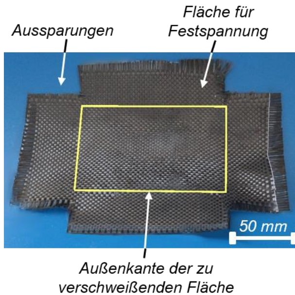
Abbildung 4.48: Zurechtgeschnittenes Gewebe aus Kohlenstofffasern [57].
