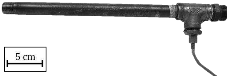
Abbildung 4-6: Messvorrichtung für die Temperatur des Wärmeträgermediums.
