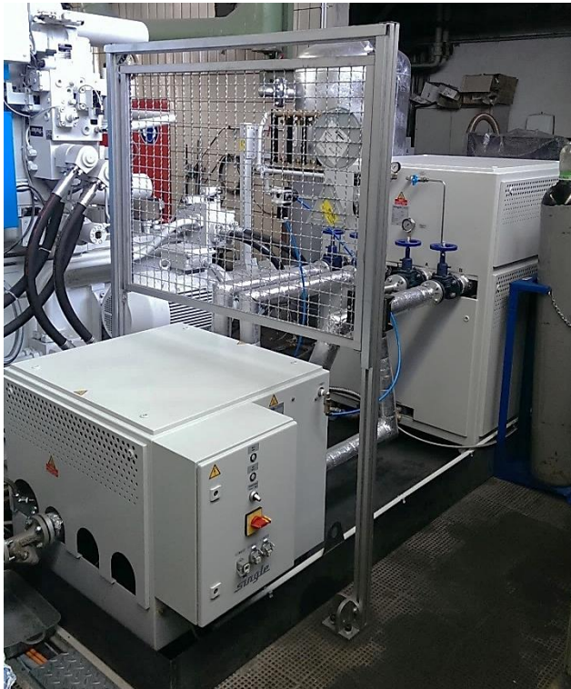
Abbildung 4-8: Variothermes Temperiergerät der Firma Single am Gießerei Institut der RWTH Aachen.
