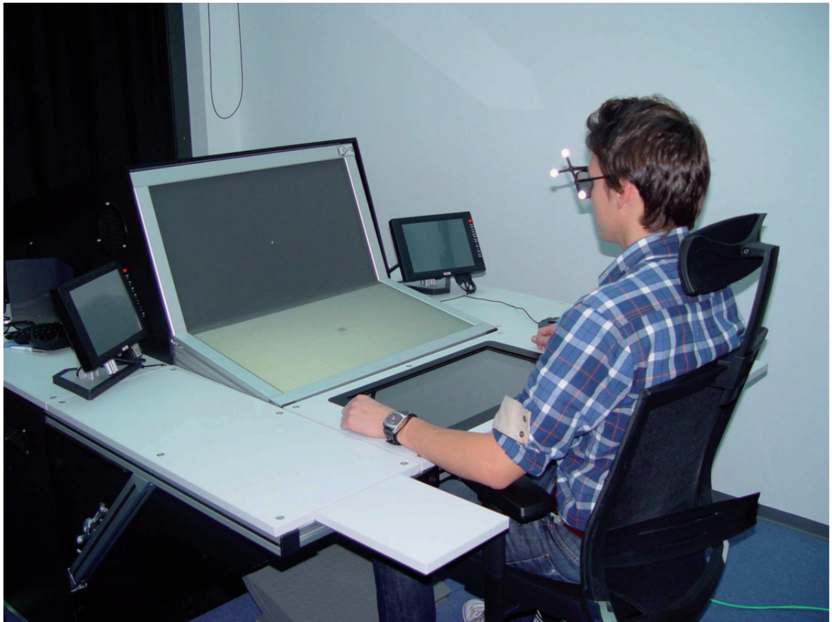
Abbildung 2.28: Fluglotsenarbeitsplatz mit stereoskopischer Visualisierung und Headtracking zur Anpassung der Perspektive (aus Wittmann et al. (2011))
