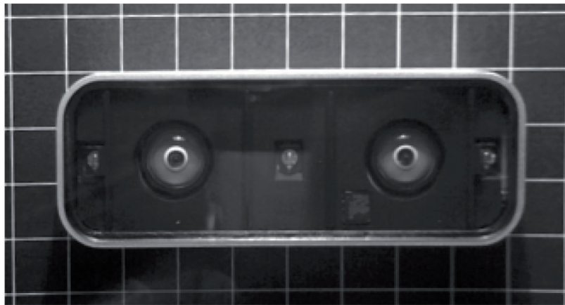
Abbildung 3.14: Leap Motion Controller ohne Abdeckung (Weichert, Bachmann, Rudak und Fisseler (2013))
