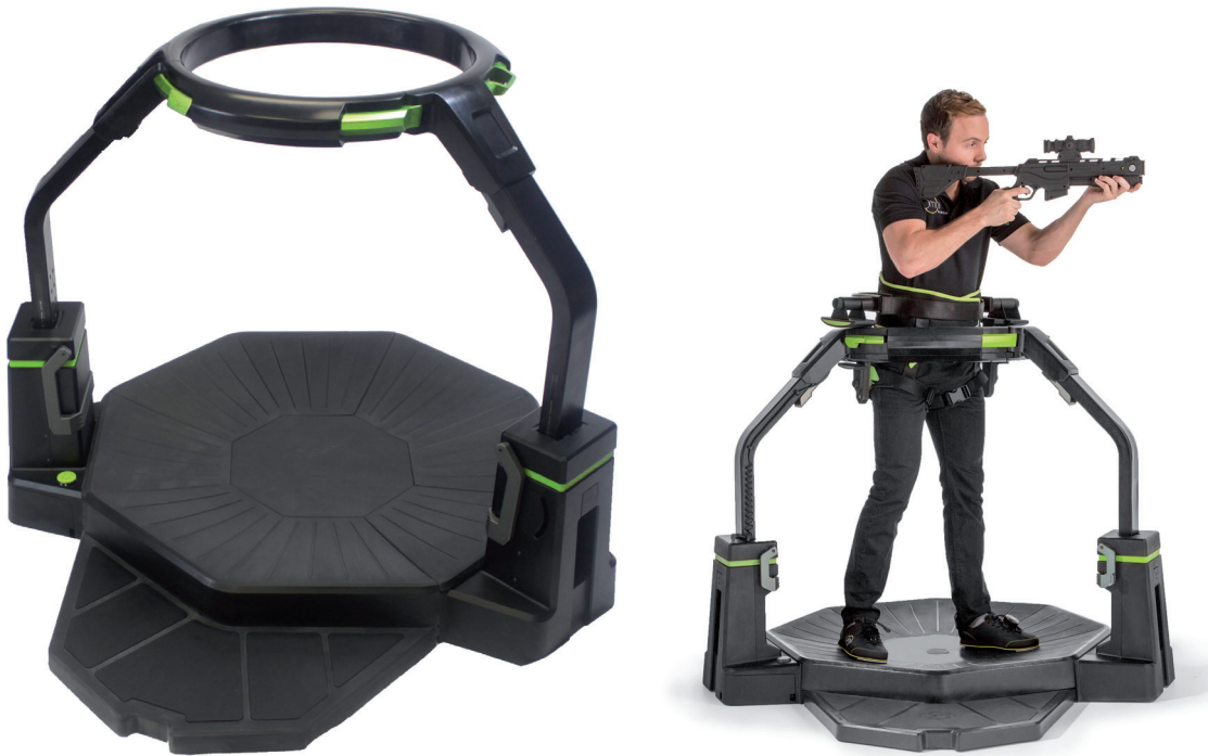
Abbildung 2.21: Virtuix Omni Treadmill: Zweidimensionale Laufbandplattform zur Steigerung der Immersion und Fortbewegung in der Virtuellen Realität
