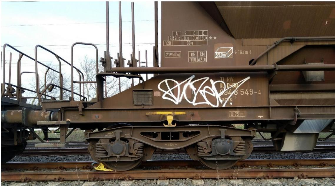
Abb. 6: Hemmschuh zur Sicherung eines Wagenzuges
