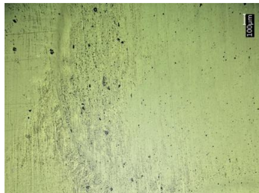
Abbildung 83. Die Kunststoffe Polystyrol (A) und Polyvinylchlorid (PVC, B) sind nicht beständig gegenüber Allicin. 20 µl einer 96 mM Allicin-Lösung wurde auf die Materialoberfläche appliziert, mit einem Petrischalen-Deckel abgedeckt, und über 18 h bei 37°C inkubiert (s. Kap. 2.2.8.1 Untersuchung der Beständigkeit der verschiedenen Materialien gegenüber Allicin zu Bau der Lungen-Simulationsapparatur). Die Oberfläche wurde mit Hilfe einer Fotokamera bzw. einem Digitalmikroskop (Keyence VHX-6000 mit DIK Universalobjektiv VH-Z100UR) aufgenommen.
