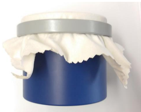
Abbildung 16. Replikatorstempel mit dem gespannten Transfertuch für die Übertragung der Bakterien von einer bewachsenen auf eine neue Agar-Platte.
