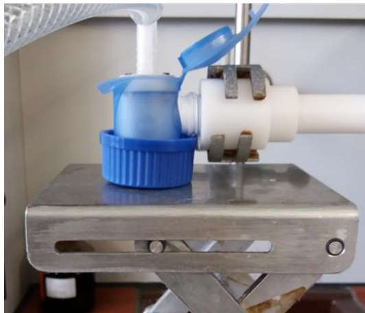
Abbildung 29. Versuchsaufbau bei der Behandlung mit dem Allicin über die Gasphase. Anstatt eines Vernebler-Gefäßes, das bei der Aerosol-Behandlung benutzt wird, wurde die Test-Lösung in einen Deckel der Schott-Flasche gefüllt und mit Hilfe der Hebebühne an die Apparatur gebracht.
