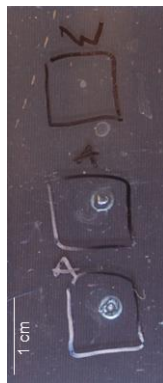
Abbildung 83. Die Kunststoffe Polystyrol (A) und Polyvinylchlorid (PVC, B) sind nicht beständig gegenüber Allicin. 20 µl einer 96 mM Allicin-Lösung wurde auf die Materialoberfläche appliziert, mit einem Petrischalen-Deckel abgedeckt, und über 18 h bei 37°C inkubiert (s. Kap. 2.2.8.1 Untersuchung der Beständigkeit der verschiedenen Materialien gegenüber Allicin zu Bau der Lungen-Simulationsapparatur). Die Oberfläche wurde mit Hilfe einer Fotokamera bzw. einem Digitalmikroskop (Keyence VHX-6000 mit DIK Universalobjektiv VH-Z100UR) aufgenommen.
