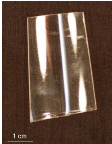
Abbildung 82. Die Kunststoffe Polymethylmethacrylat (PMMA, A) und Polyetheretherketon (PEEK, B) sind nicht beständig gegenüber Allicin. Polyethylenterephthalat (PET, C) von einer Getränkeflasche weist nach der Behandlung mit Allicin keine sichtbaren Spuren an der Oberfläche auf. Im Gegensatz dazu entstehen auf der 75 µm dicken PET-Folie weiße Verfärbungen. 20 µl einer 96 mM Allicin-Lösung (bei PET-Folie 20 µl von 15 mM bzw. 30 mM Allicin-Lösung) wurde auf die Materialoberfläche appliziert, mit einem Petrischalen-Deckel abgedeckt, und über 18 h bei 37°C inkubiert (s. Kap. 2.2.8.1 Untersuchung der Beständigkeit der verschiedenen Materialien gegenüber Allicin zu Bau der Lungen-Simulationsapparatur). Die Oberfläche wurde mit Hilfe einer Fotokamera bzw. einem Digitalmikroskop (Keyence VHX-6000 mit DIK Universalobjektiv VH-Z100UR) aufgenommen.
