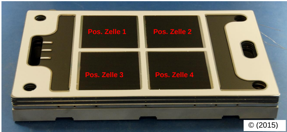
Abbildung 5.6: Luftseite einer Interkonnektorplatte im Y8-Design. Optisch erkennbar ist das Fensterdesign mit den einzelnen Zellenpositionen. [153]
