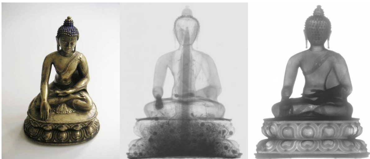
Abbildung 1.1: Archäologische Probe (Tibetische Buddhastatue aus Messing aus dem 15. Jahrhundert), die an der Neutronenquelle SINQ am Paul-Scherer-Institut (PSI) mit Neutronen (2. Bild) und mit Röntgenstrahlen (3. Bild) durchleuchtet wurde. Der Neutronenstrahl hat getrocknete Blumen und Holzgegenstände, die im Inneren der Probe verborgen waren, aufgespürt. Wohingegen der Röntgenstrahl die Messinghülle nicht durchdringen konnte [Fotos vom PSI]
