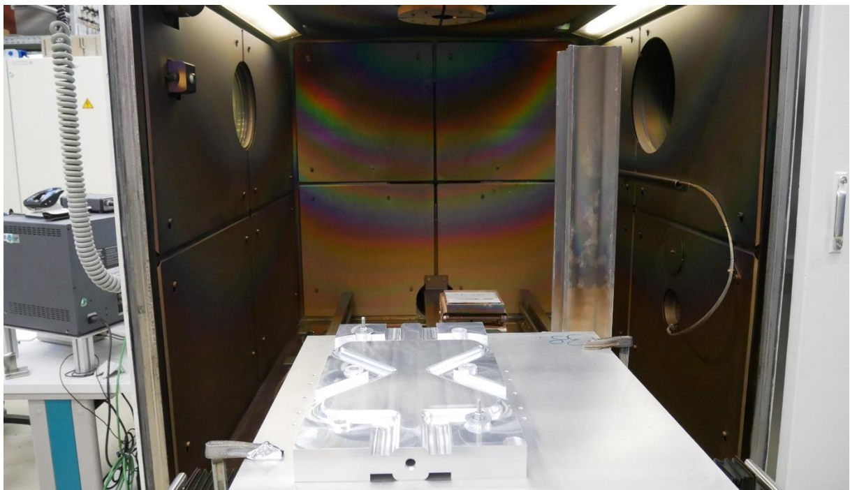
Abbildung 7.3: Elektronenstrahlschweißen des BF1-Moderator Prototyps
