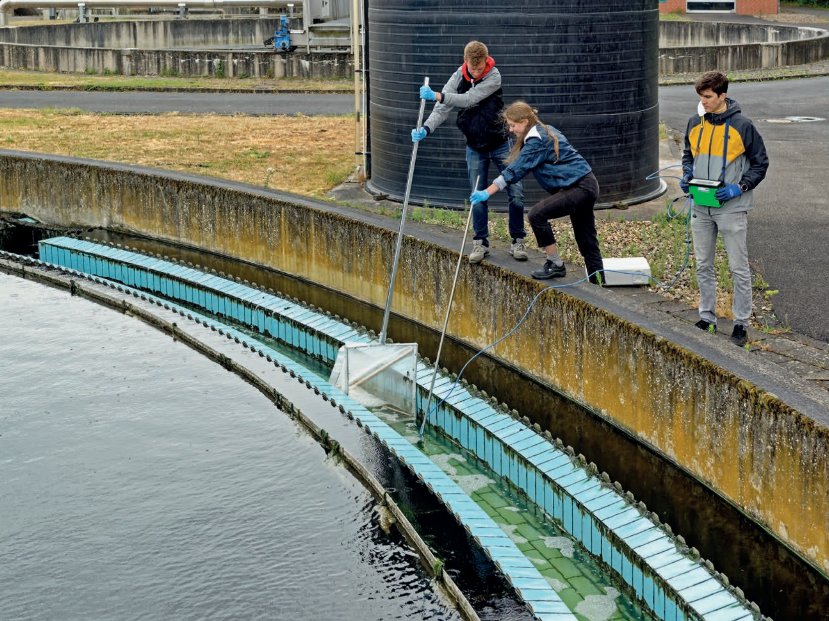
Bild 4: Probenahme im Ablauf eines Nachklärbeckens Foto: Peter Winandy
