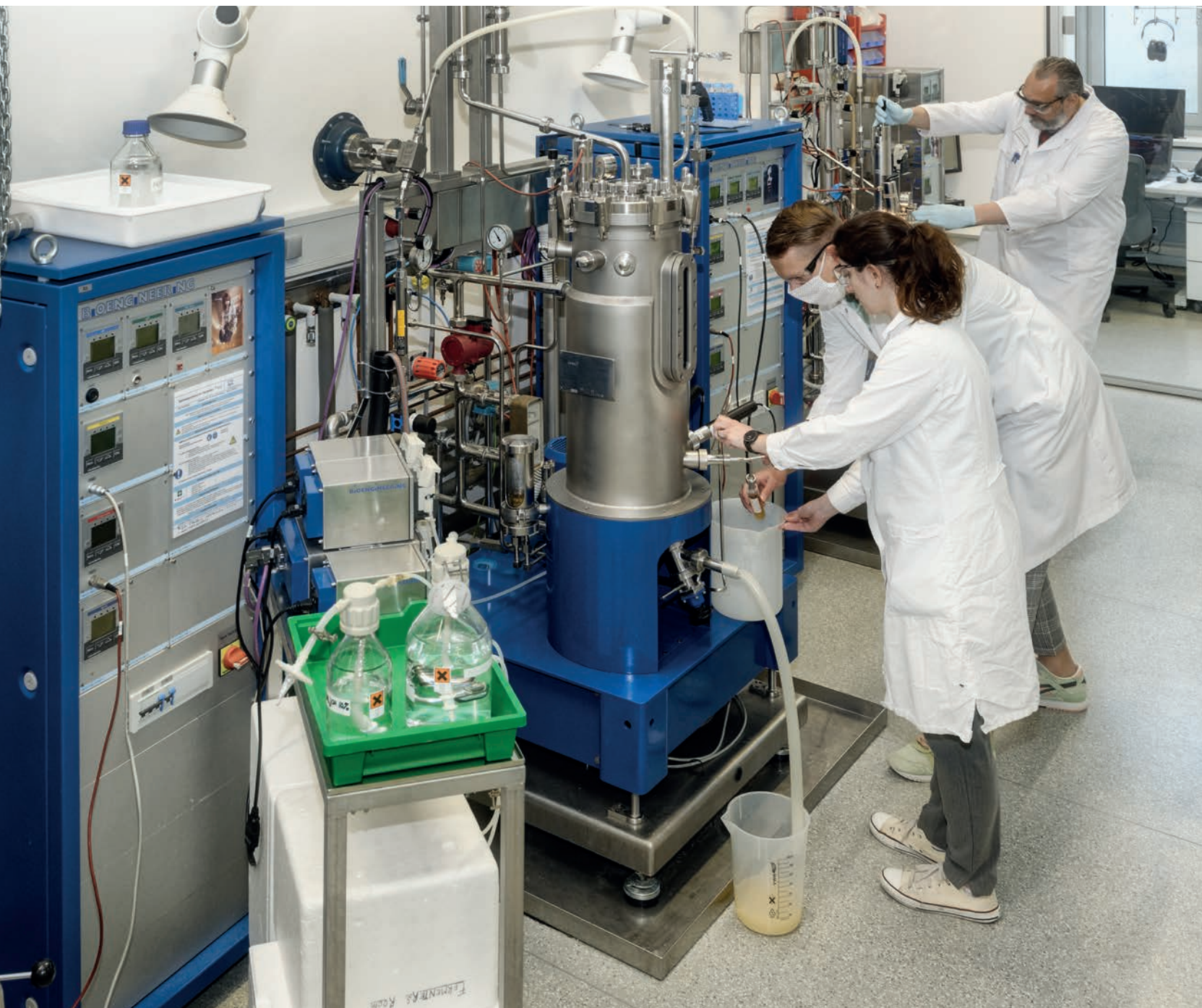
Bild 1: Fermentation zur Herstellung von Enzymen für die Degradation von Mikroplastik in Bestandteile niedrigerer Molmasse. Foto: Peter Winandy
