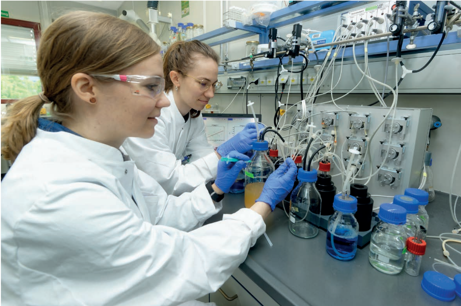
Bild 2: Aufbau eines Versuchs zur adaptiven Laborevolution im Bioreaktor Foto: Peter Winandy
