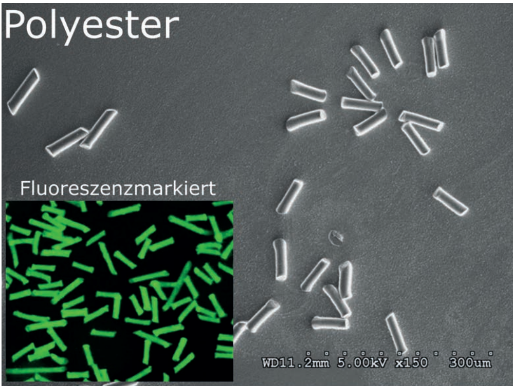
Bild 3: Faseriges Modellmikroplastik mit 55 µm Länge aus Nylon-6 (oben) und Polyester (unten) sowie die fluoreszenzmarkierten Partikel (eingefügt)
