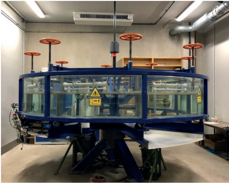
Bild 3: Kreisgerinne des Instituts für Wasserbau und Wasserwirtschaft (links) und Erosionsprozess einer Mikroplastikkugel (rechts).
