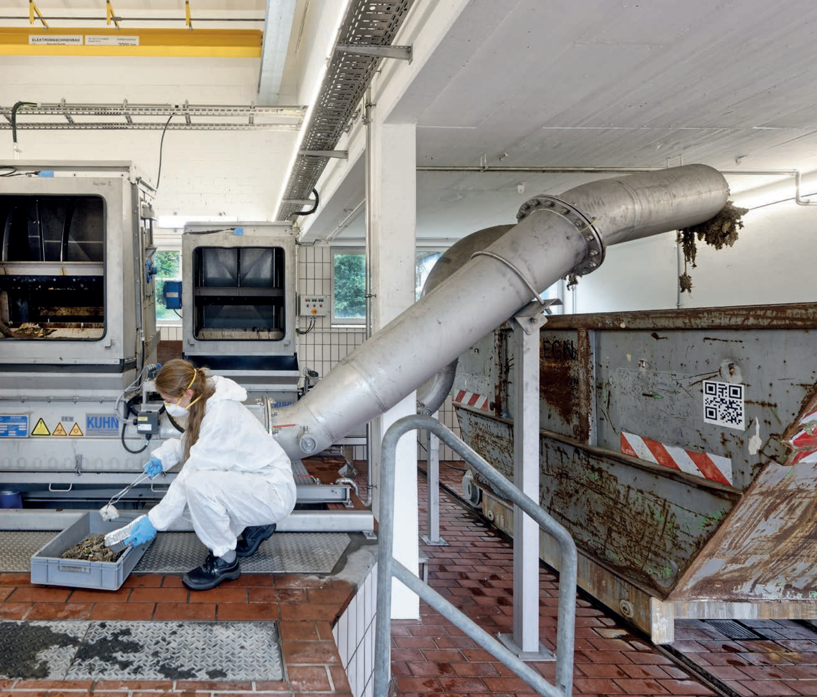
Bild 1: Beprobung von Feststoffen am Rechen einer Kläranlage Foto: Peter Winandy
