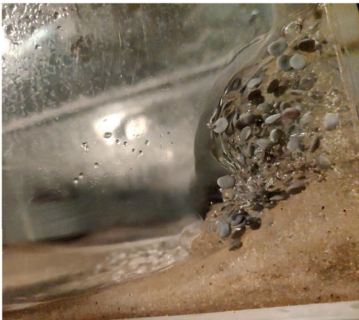
Bild 4: Numerische Simulation (links) und physikalische Modellierung (rechts) einer brechenden Welle zur Verteilung von Mikroplastik in der Brandungszone.
