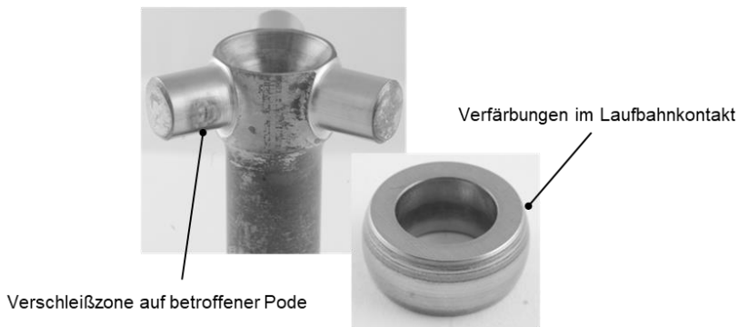
Abbildung 68: Schadensbilder Tripode 19°, Maximallastversuch
