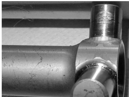
Abbildung 72: Schadensbilder Tripode 6, Dauerlaufversuch
