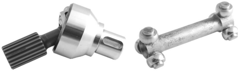
Abbildung 15: Aus PKW-Bereich übernommene Gelenkbauarten für Einsatz im Schrägachsenmotor: Links ein Kugelgleichlaufgelenk, rechts ein (Doppel-)Tripodegelenk
