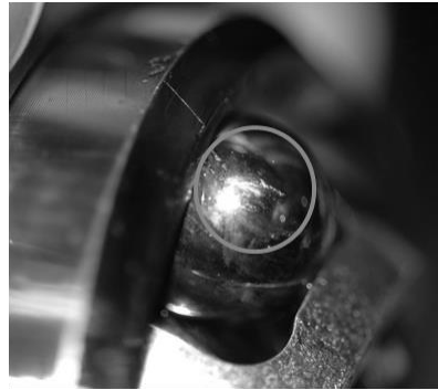
Abbildung 75: Schadensbilder Kugelgleichlaufgelenk 6°, Dauerlaufversuch
