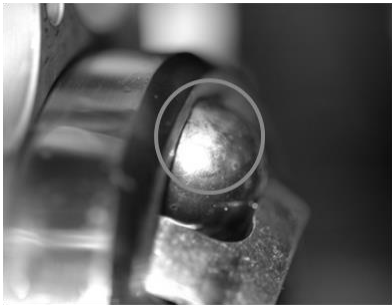
Abbildung 75: Schadensbilder Kugelgleichlaufgelenk 6°, Dauerlaufversuch
