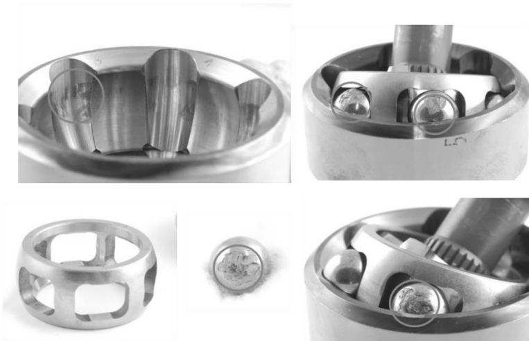
Abbildung 76: Schadensbilder Kugelgleichlaufgelenk 19°, Dauerversuch
