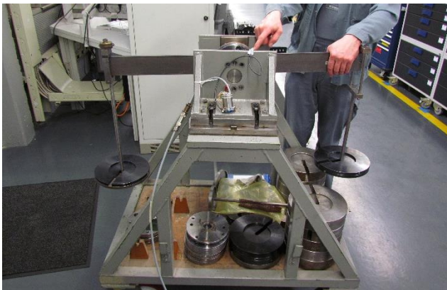
Abbildung 41: Kalibriereinrichtung zum Kalibrieren der Messgelenke
