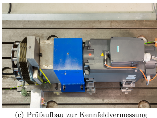
Figure 6.12: Stator und Rotor des Prototyps sowie dessen Prüfaufbau
