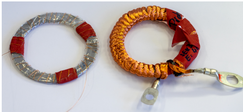
Figure A.2: Ringproben mit Erreger- und Messwicklung zur Vermessung der Permeabilität \mu_r
