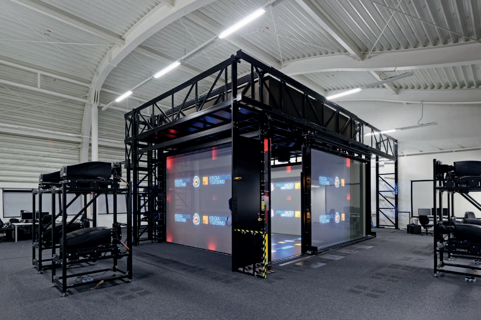
Bild 2: Die aixCAVE am IT Center ist eine fünfseitige Virtual-Reality-Installation zur Darstellung immersiver, virtueller Umgebungen. Das Akustiksystem oberhalb der aixCAVE wird zur Beschallung des Benutzers eingesetzt und ermöglicht so eine multimodale Darbietung virtueller Umgebungen.
