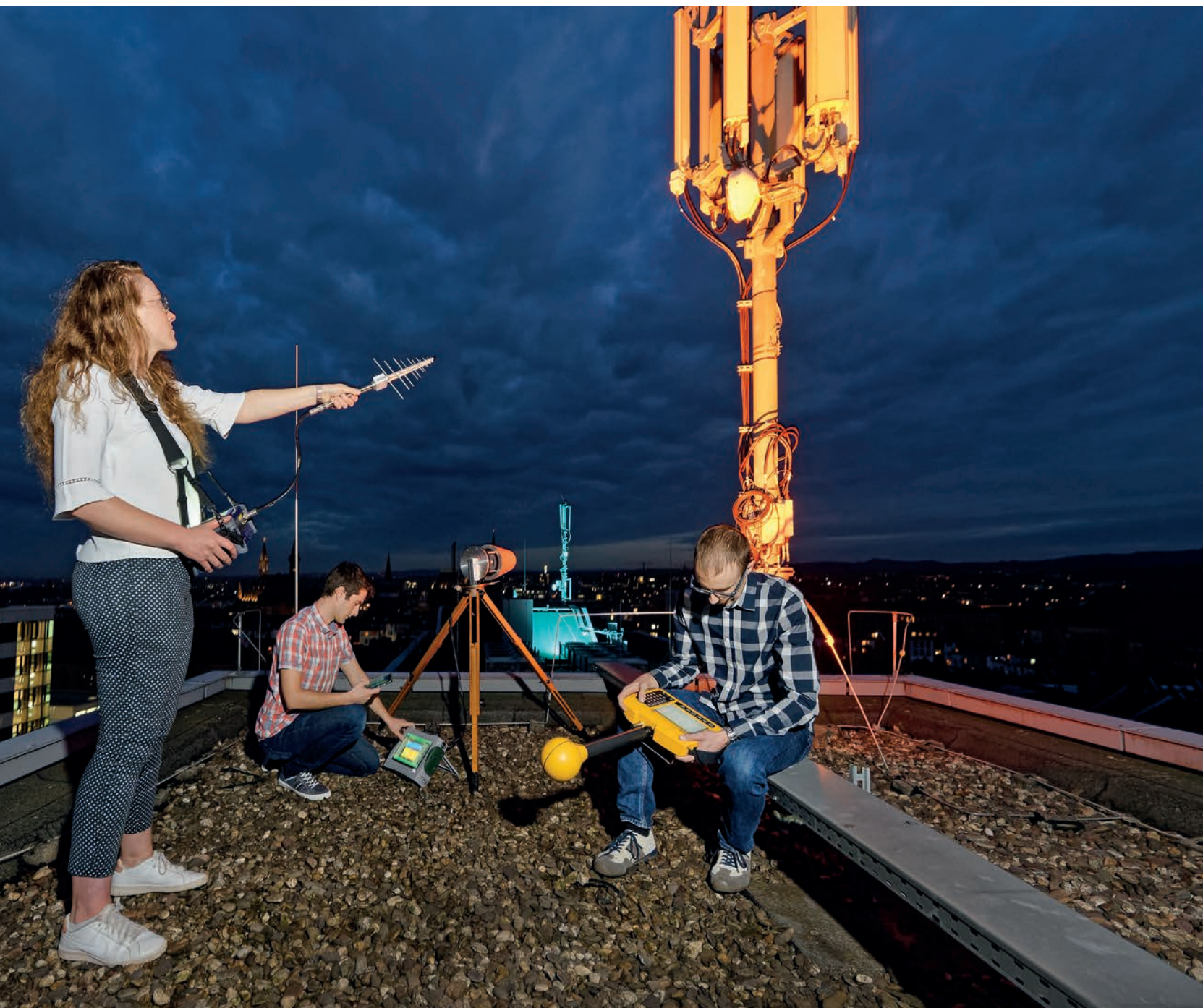
Bild 1: Durchführung einer Messung von Mobilfunkimmissionen an einem Dachstandort. Foto: Peter Winandy
