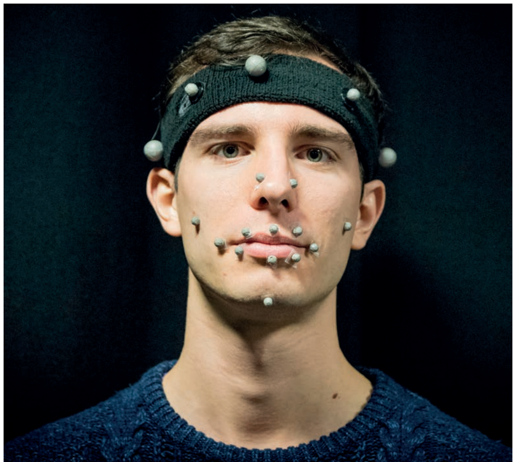
Bild 3: Die Gesichtsbewegungen eines Schauspielers werden anhand mehrerer optischer Marker aufgenommen um über die sich ändernden Mundformen auch eine Phonem-basierte Richtwirkung des Schalls zu berechnen.
