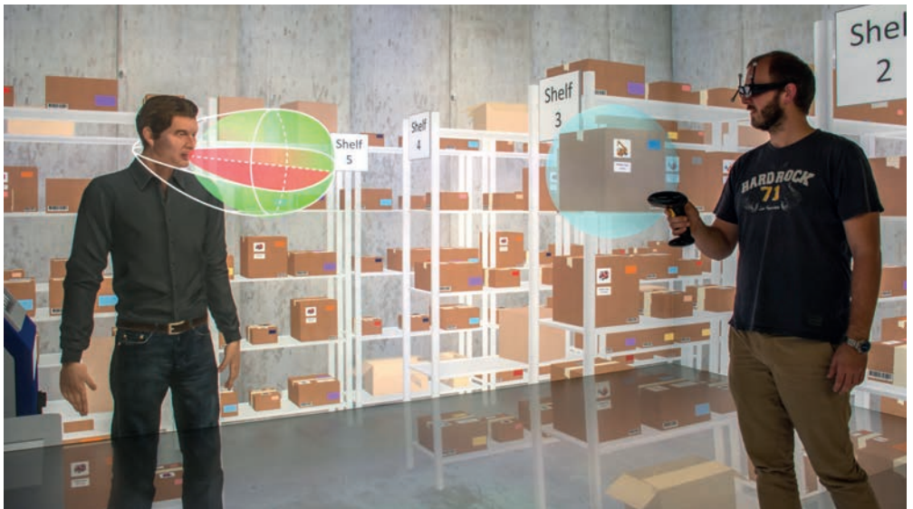
Bild 5: Zusammenarbeit mit einem virtuellen Agenten: Ein Studienteilnehmer unterstützt den Agenten in einem virtuellen Lagerhaus bei der Suche nach bestimmten Artikeln. Hierbei werden verschiedene Richtcharakteristiken von Sprache untersucht (hier beispielhaft visualisiert).
