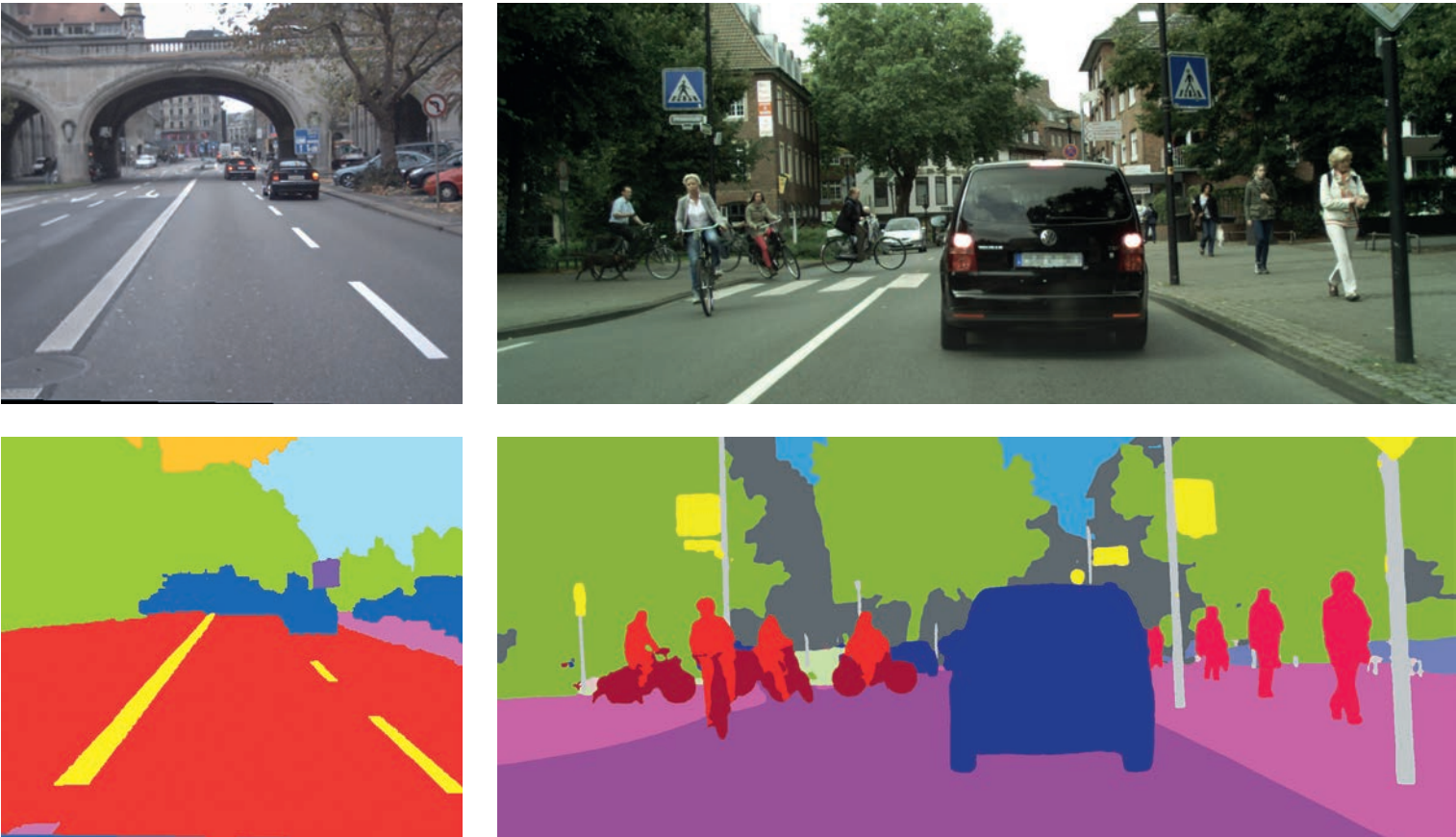
Bild 2: Vergleich der erreichbaren semantischen Segmentierungsergebnisse zweier State-of-the-art-Ansätze aus 2012 (links, [1]) und 2017 (rechts, [2], Bilder aus den jeweiligen Publikationen). Über einen Zeitraum von nur fünf Jahren ermöglichte das bessere Verständnis von Deep-Learning-Ansätzen einen Fortschritt von einer groben Klassifizierung semantischer Bildregionen hin zu einer fast pixelgenauen semantischen Interpretation komplexer Straßenszenen. (Die verschiedenen semantischen Bildregionen sind hier durch unterschiedliche Farben gekennzeichnet; die Zuordnung der Farben zu semantischen Klassen ist aber in beiden Bildern unterschiedlich).
