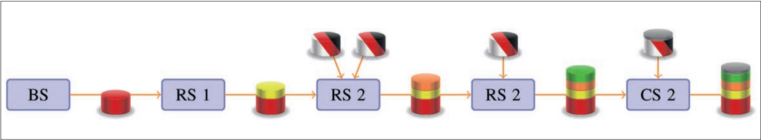
Bild 3: Schematischer Produktionsablauf zur Herstellung eines C3-Produkts, bestehend aus einer Basis, drei Ringen und einem Deckel.
