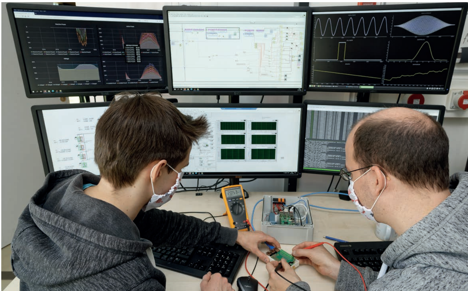
Bild 1: Prüfung eines Edge Device für Stromnetze. Foto: Peter Winandy
