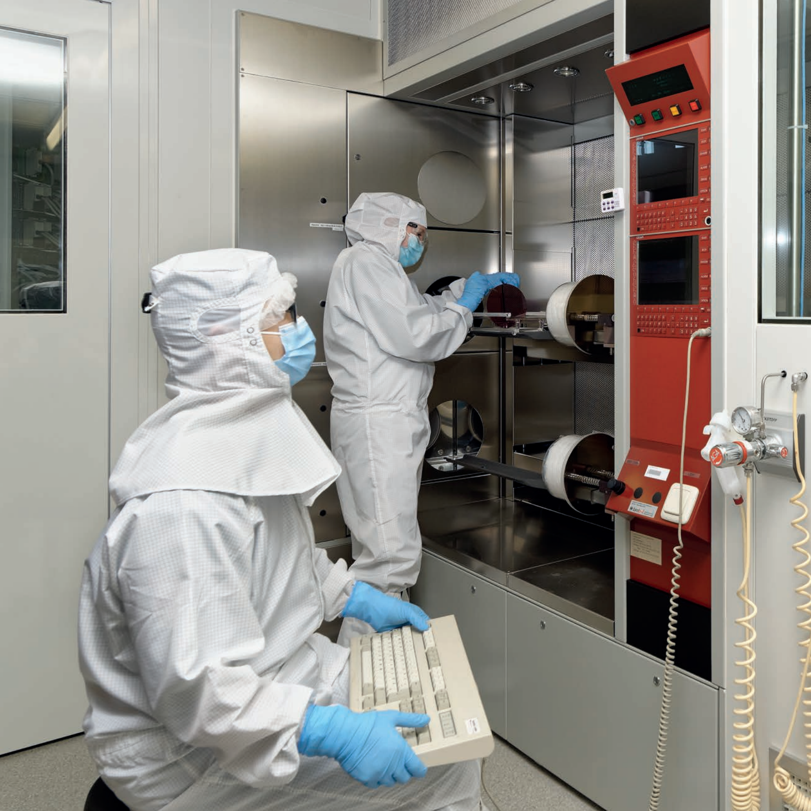
Bild 6: Beladung des Diffusionsofens mit Siliziumscheiben von 150 mm Durchmesser.
