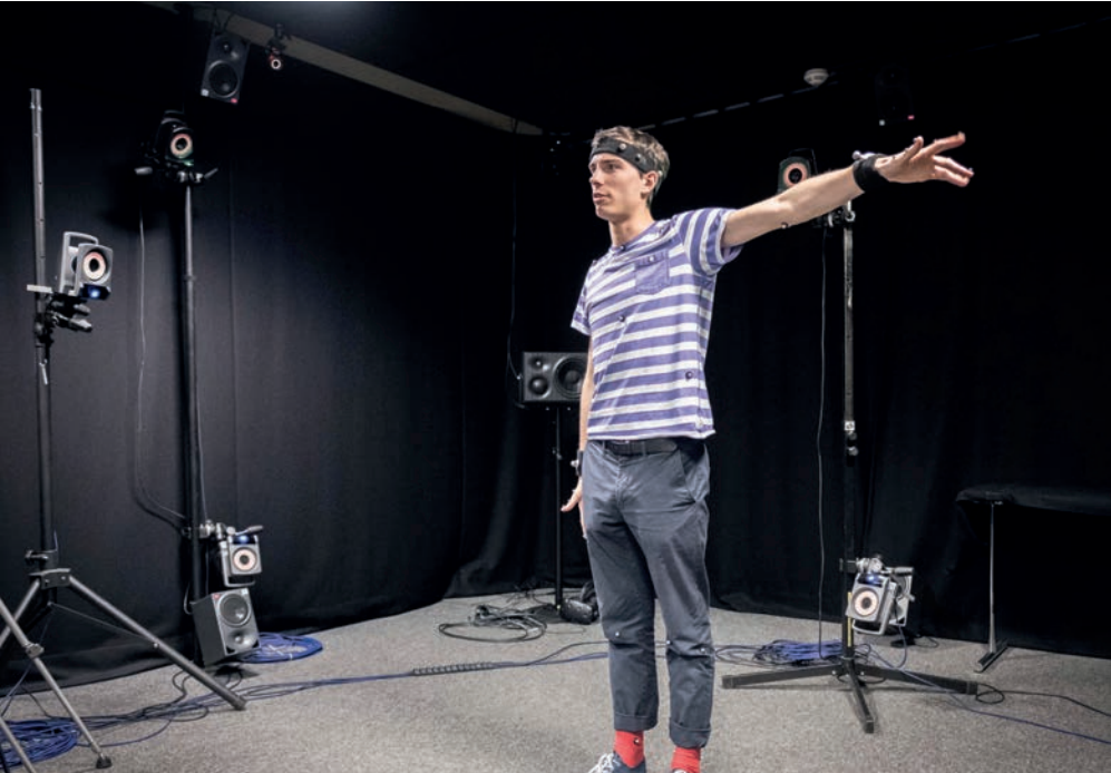
Bild 8: Ein Schauspieler während der Aufnahme von sprachbegleitenden Gesten mithilfe eines optischen Motion Capturing Systems. Die Gesten wurden anschließend verwendet um einen virtuellen Agenten in einer Studie zu animieren.
