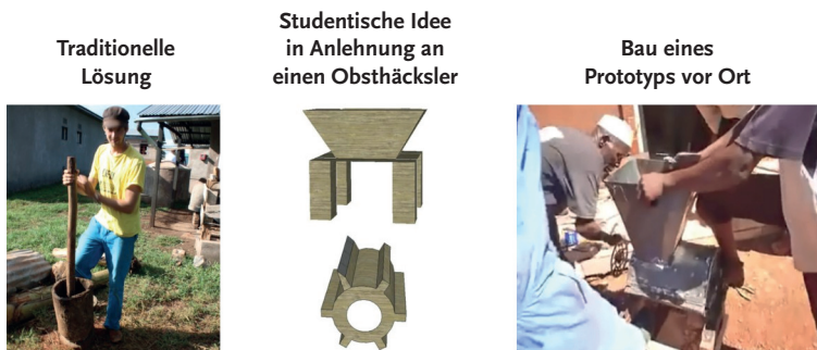
Abbildung 2: Studentische Lösung einer mechanischen Zerkleinerungshilfe für Bananenstauden in Tansania
