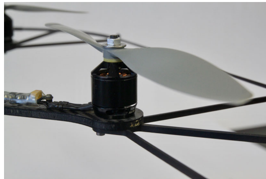
Abbildung 5.2: Rotor mit Brushless-Motor
