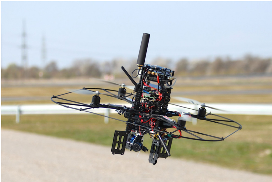
Abbildung 6.12: Erprobung des experimentellen GPS- und Galileo-Empfängers auf dem Quadroko­pter im automotiveGATE
