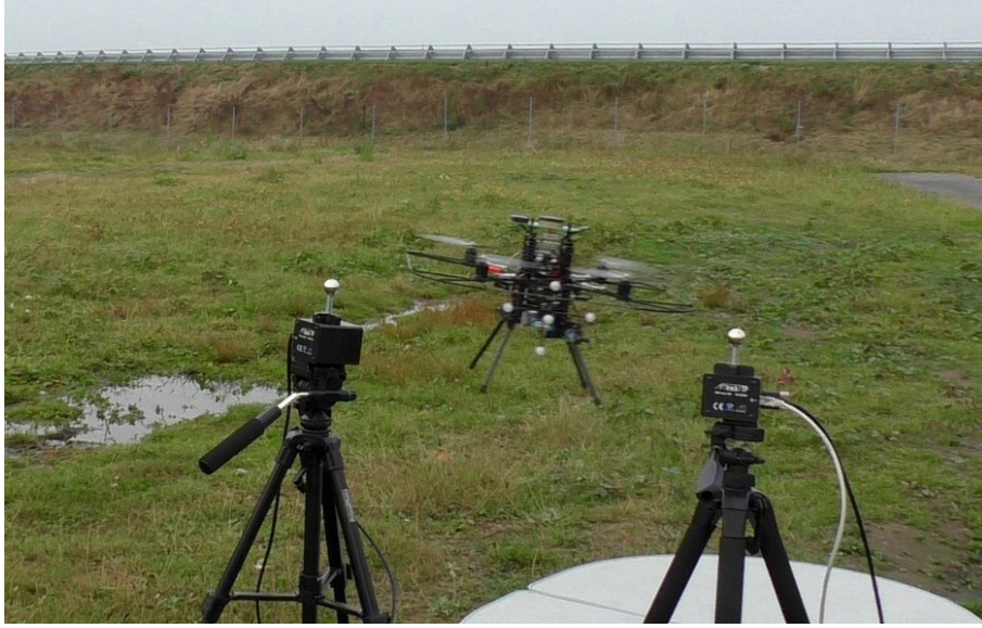
Abbildung 6.1: Flugversuch zur Validierung der Sensorfusion: Im Vordergrund sind die beiden Infrarotkameras des Tracking-Systems zu sehen. Die fünf hellgrauen Kugeln am Quadrokopter sind die Infrarot-Marker
