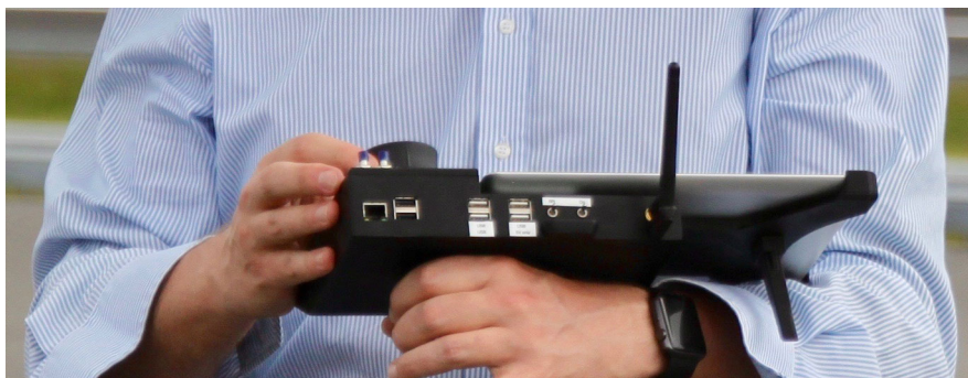
Abbildung 6.20: Steuerung des Quadrokopters mit dem 6-Achs-Joystick des ControlPads
