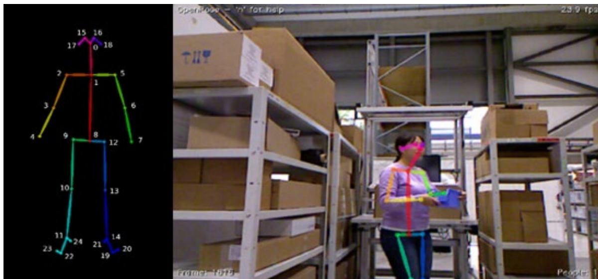
Abbildung 71: Auswertung der Körperpositionen mit „Body25“ von OpenPose
