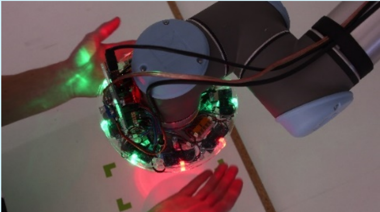
Abbildung 94: UR10 mit Ultraschallsensoren zur Werkzeugabsicherung
