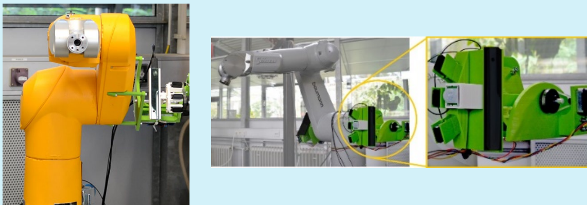
Abbildung 92: Links: Stäubli TX40; Rechts: Stäubli TX60L jeweils ausgestattet mit seitlich geführten Ultraschallsensoren
