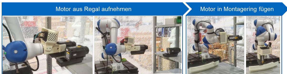
Abbildung 14: Aufnehmen eines Motors aus dem Regal und Fügen des Motors in den Montagering
