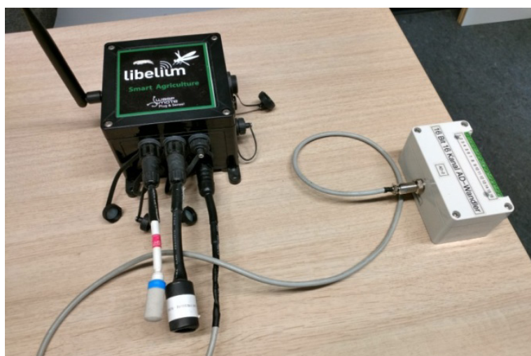
Abbildung 4: Waspote mit angeschlossener A/D-Wandler Box.
