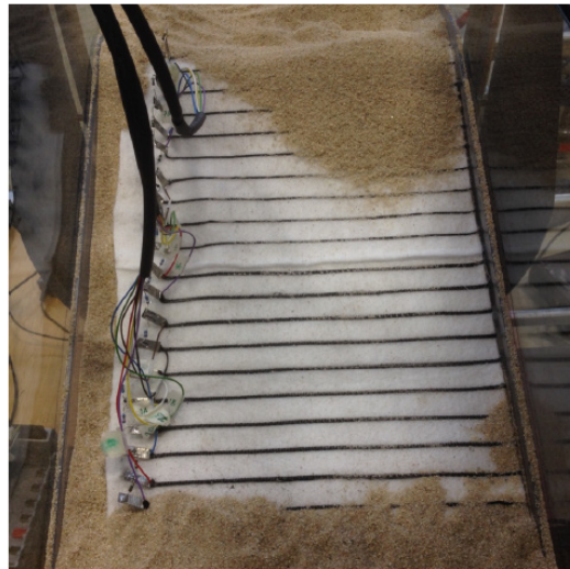
Abbildung 2: Prototyp des Messvlieses im kleinmaßstäblichen Deichmodell (Foto: Krebs 2015).
