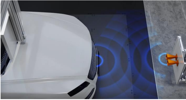
Bild 7b Wirkprüfung von ACC und AEB in KÜS DRIVE (Quelle: KÜS)
