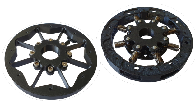
Abbildung 3 Prototypen des ersten Mechanismus in denen die Federn als Biegefedern (links) und Spiralfedern realisiert sind.
