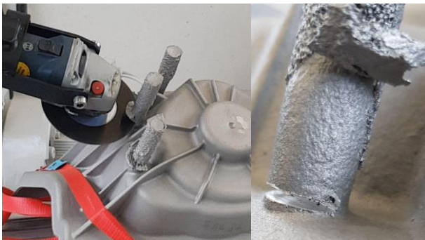
Bild 8 Ausführung des realen Prozesses (links) und Schnittergebnis der Speisertrennung (rechts)
