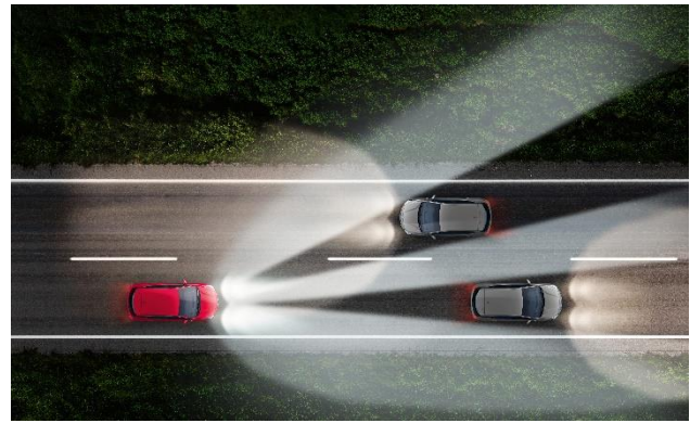
Bild 4 Funktionsdarstellung des adaptiven Fernlichts (Quelle: Opel Media/Stellantis)
