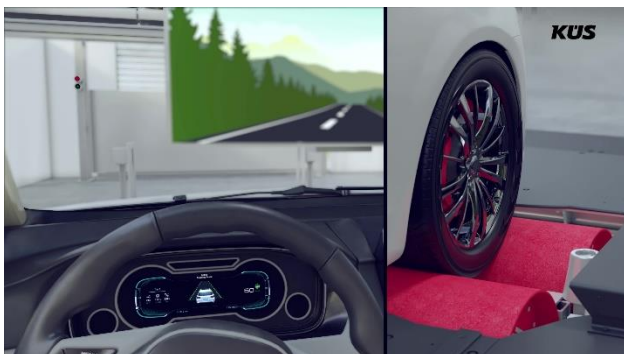
Bild 6 Wirkprüfung von LKA in KÜS DRIVE (Quelle: KÜS)
