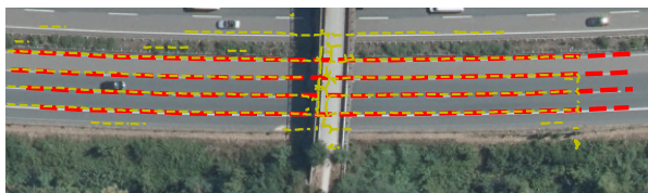
Abbildung 7 Verdeckung in Luftbildern erschwert die Detektion von Spurmarkierungen. Fehldetektionen auf benachbarten Fahrbahnen schränken die direkte Verwendung des Ergebnisses in einer HD-Karte deutlich ein.
