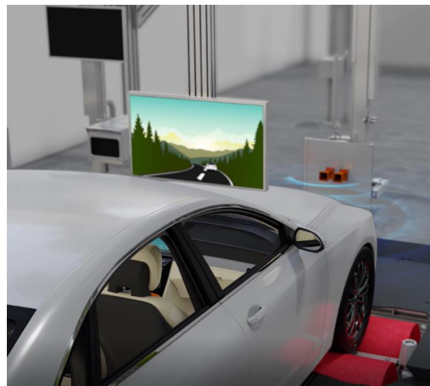
Bild 7a Wirkprüfung von ACC und ABE in KÜS DRIVE (Quelle: KÜS)
