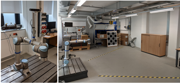
Abbildung 1 Aufbau im Labor des IGMR: 3D-Kamera (Orbbec Astra Pro) montiert auf UR10e Roboterarm
