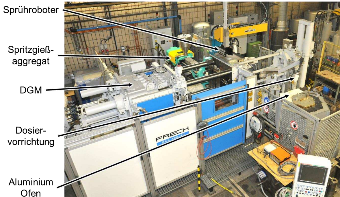
Abbildung 4-2: Fertigungszelle für das Mehrkomponenten-Druckgießen am Gießerei-Institut der RWTH Aachen
