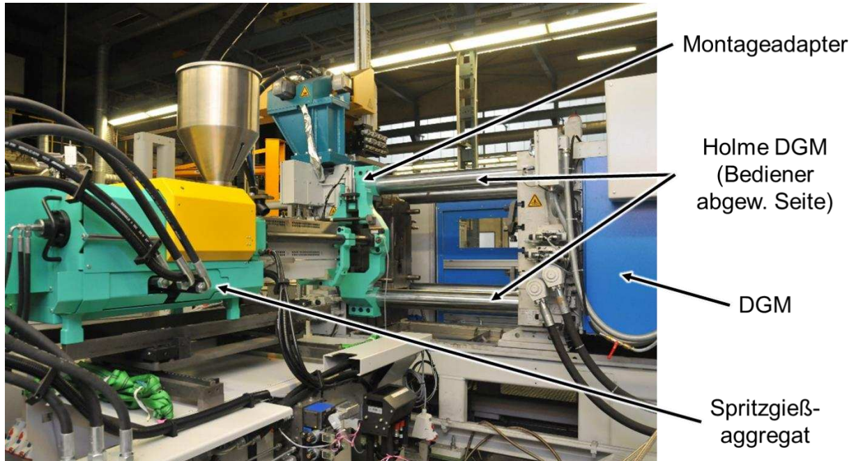
Abbildung 4-3: Anbindung des Arburg-Spritzgießaggregats an die Frech-DGM
