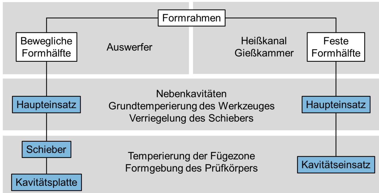
Abbildung 5-10: Hierarchie und Zuordnung der grundlegenden Funktionen innerhalb des Hybrid III-Werkzeuges
