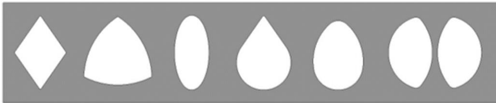
Abbildung 3-8: Beispielquerschnitte für Kühlkanäle zur Vermeidung von Überhängen ([82]; Ursprungsquelle: Fraunhofer ILT)
