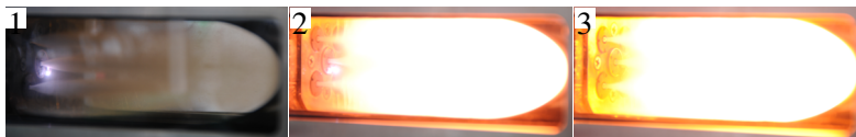
Abbildung 3.2.: Bildsequenz für einen erfolgreichen Zündversuch in einer optisch zugänglichen Brennkammer mit Laserzünder am Teststand M3.1
