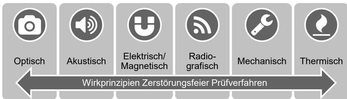
Abb. 4.5: Klassifizierung der ZfP nach physikalischem Wirkprinzip
