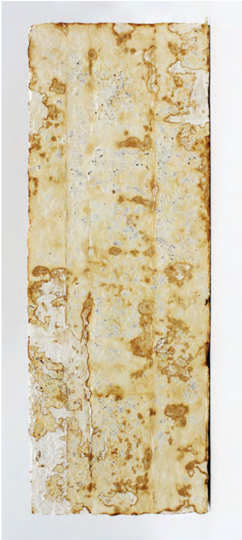
Bild 3 : Prototyp der Verbundwand. Das Pilzmyzel ermöglicht die Verbindung der einzelnen Elemente in einem zweistufigen Wachstumsprozess.
