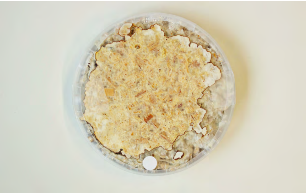
Bild 1: Substrat-Pilz-Myzel-Wachstumsverhältnistest mit Buchenholzspänen (grob und fein) und Ganoderma Lucidum in einer Petrischale.
