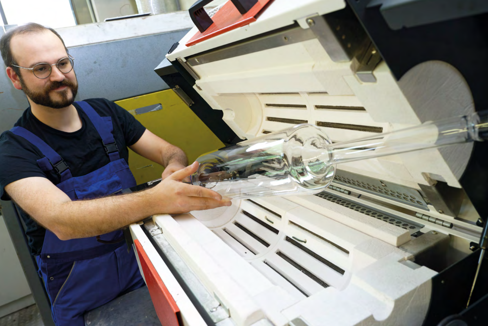
Bild 1: Thermische Vorbehandlung im Labormaßstab in einem Drehrohrföfen
