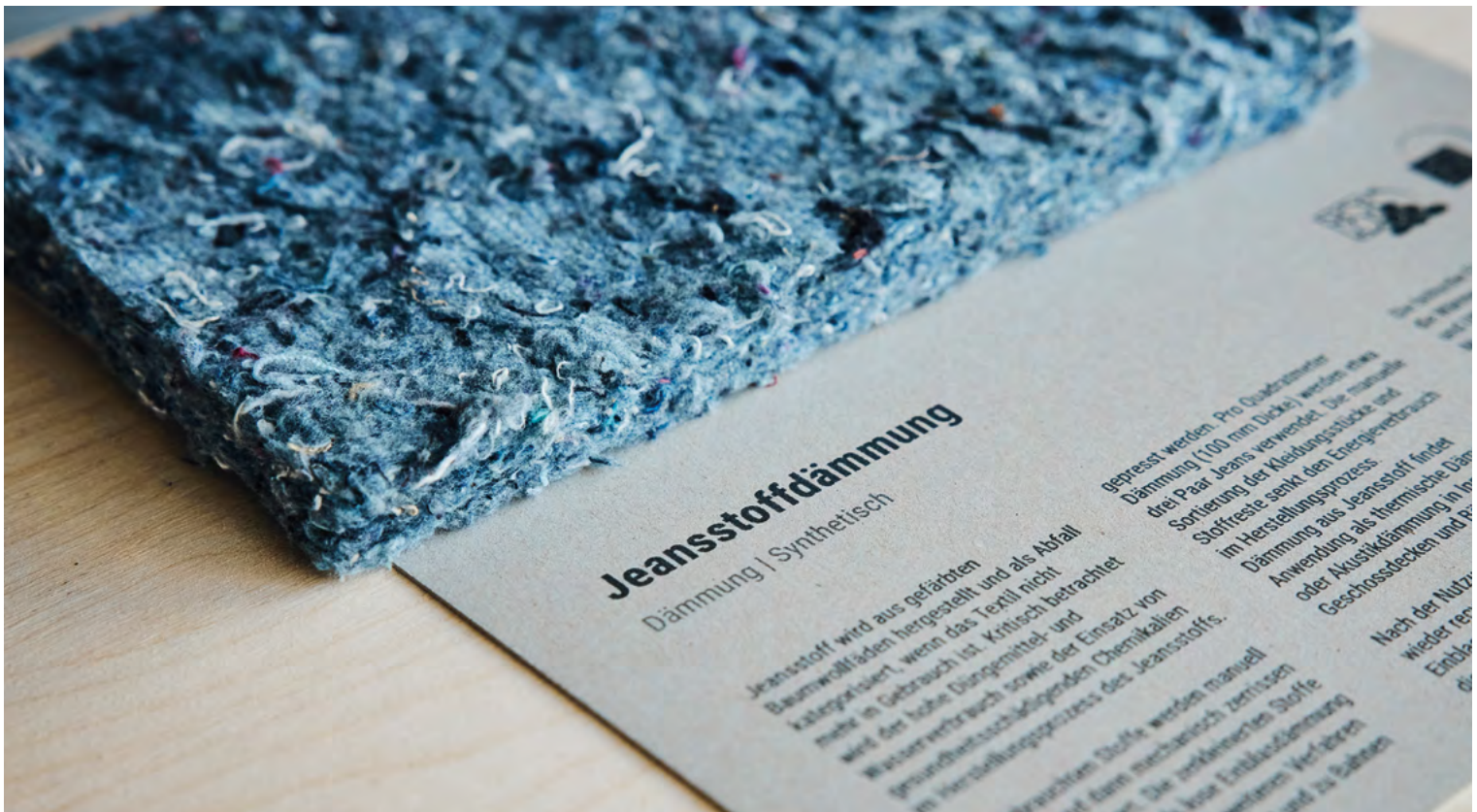
Bild 2: Dämmung aus Sekundärrohstoffen Foto: Lisa Beller
