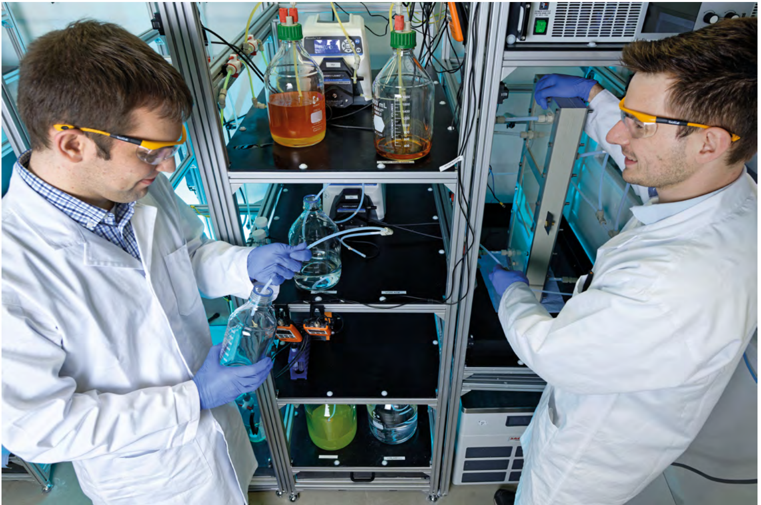
Bild 6: Probenahme am Membranmodul zur elektrochemischen pH-Wert-Einstellung Foto: Peter Winandy
