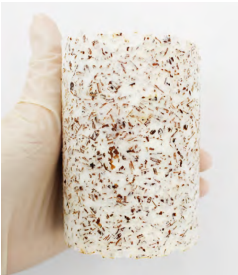
Bild 5 : Probekörper Z1 für Druckuntersuchung; Seitenansicht
