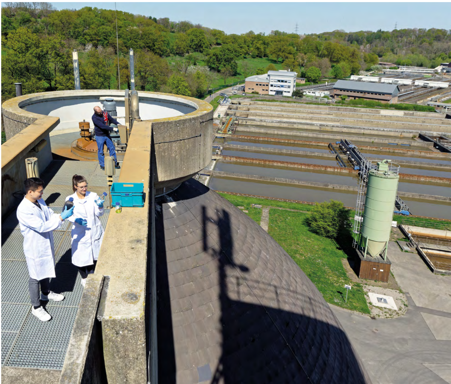
Bild 4: Probenahme von Faulschlamm auf der Kläranlage Aachen-Soers
