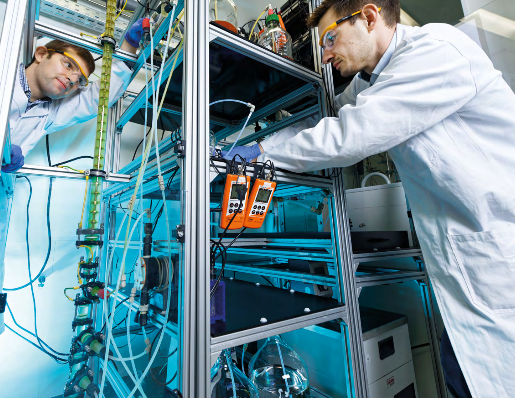
Bild 1: Versuchsstand zur elektrochemischen Aufarbeitung Foto: Peter Winandy
